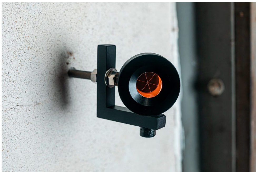
Joonis 11.2. Seinale monteeritud ringprisma 43 .
