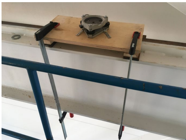
Joonis 10.7. Mittestandardne rakis laserskanneri paigaldamiseks kraanateele (Haljend, 2020).
