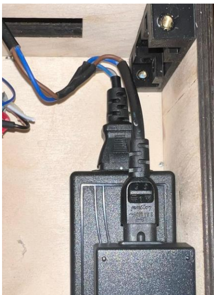
Joonis 7.1 Toiteplokkide ühendus
