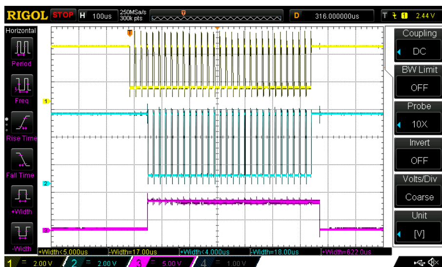
Joonis 30. Juhtkontrolleri ja kahe valgusti andmeside katsetamine.
