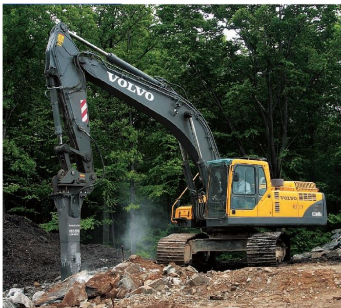
Joonis 31. Ekskavaator Volvo EC380 ja hüdrovasar Volvo HB3200. [48]
