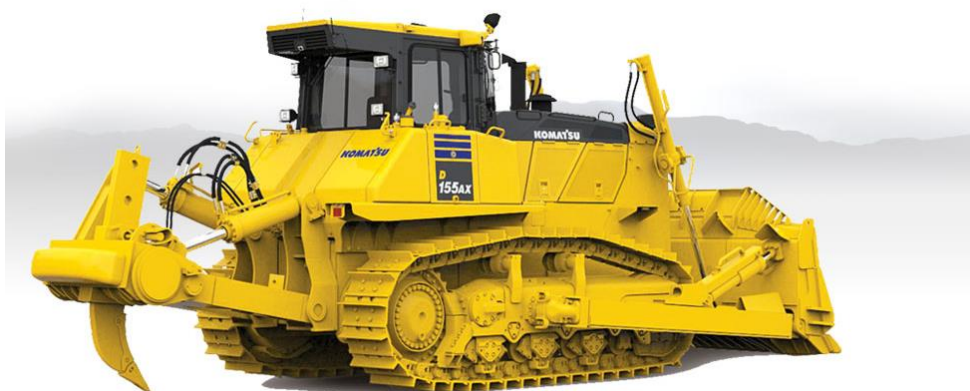
Joonis 29. Buldooser-kobesti Komatsu D155AX, massiga 40 t. [44]
