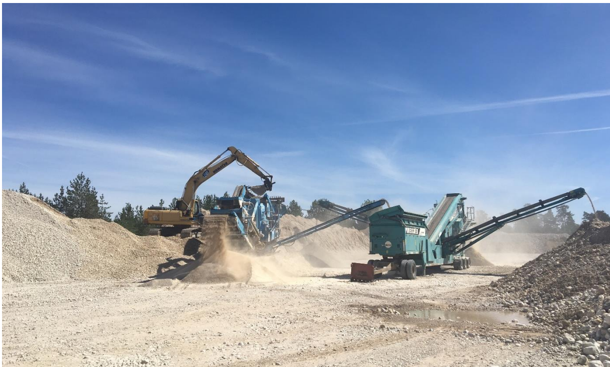
Joonis 53. Ekskavaator Komatsu PC210, koonuspurusti Pegson Powerscreen SR1000 ja sõeltekompleks Powerscreen Chieftain 2100. Foto: Erakogu, 20.07.2016 kell 14.40
