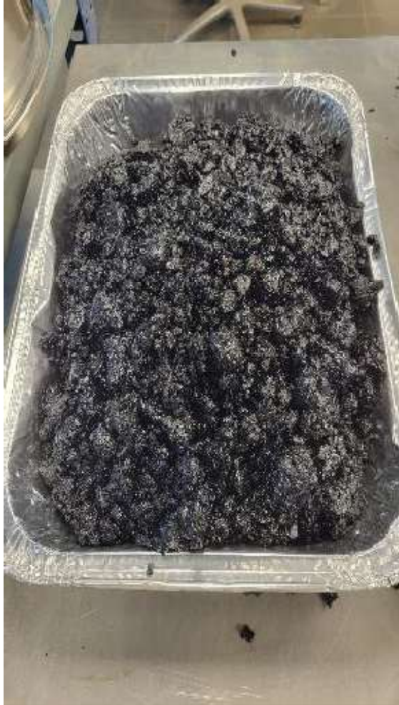
Joonis 2.11 Asfaltsegu katseproov enne ekstraheerimist.
