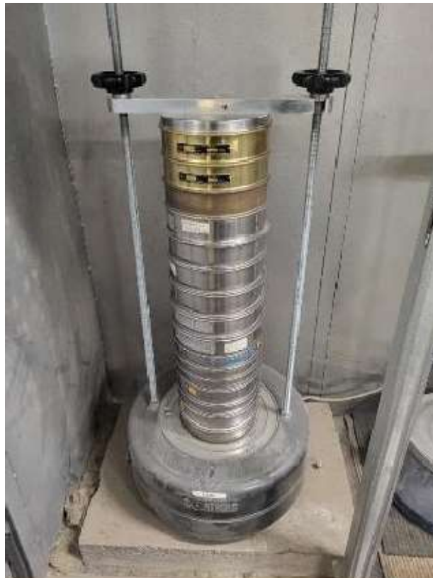
Joonis 2.10 Täitematerjali sõelumiseks kasutatav raputi ja sõelte komplekt.
