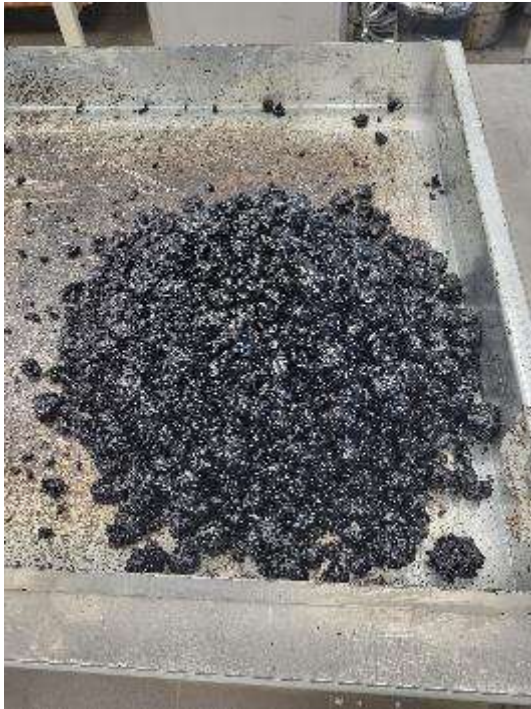
Joonis 2.4. Laborisse toodud proov (laboriproov), mis vajab vähendamist.
