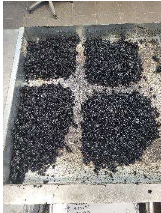
Joonis 2.5. Laboriproov kvarteeritult neljaks osaks.
