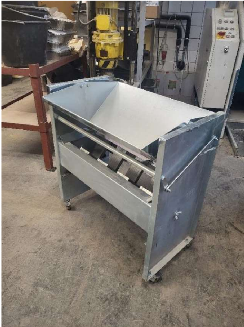
Joonis 2.3 Proovi jagamise renn.
