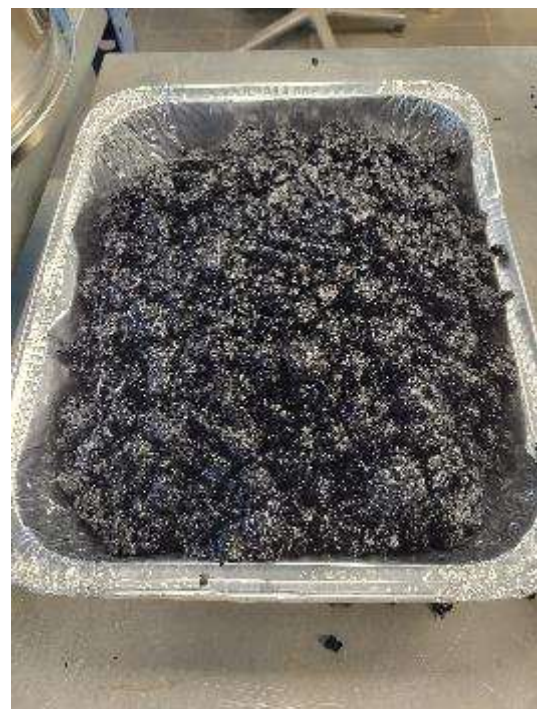
Joonis 2.7. Kahest osast moodustatud vähendatud katseproov.
