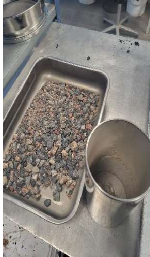
Joonis 2.12 Peale ekstraheerimist eraldatud täitematerjal.
