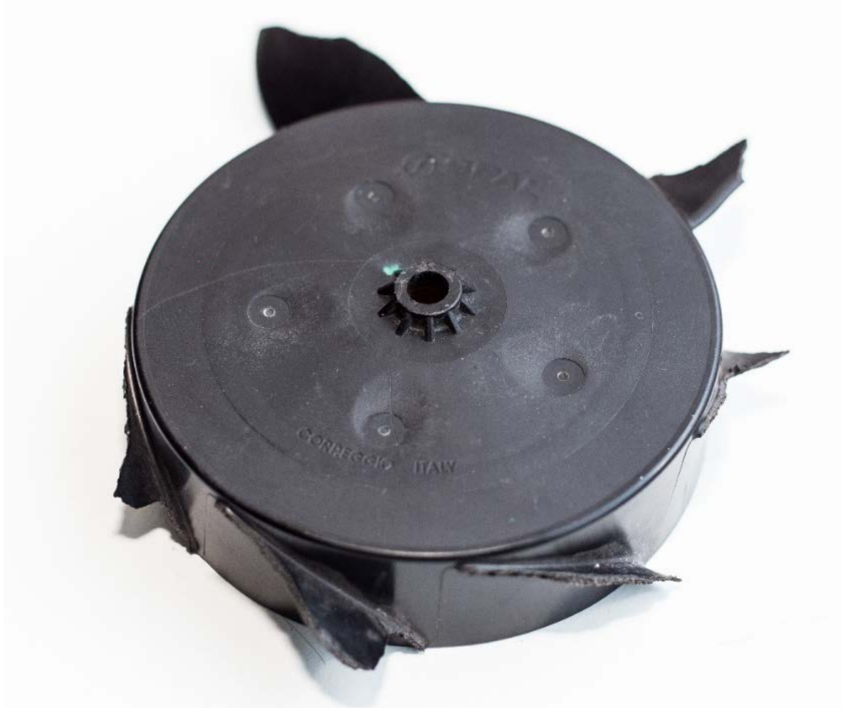
Sele 2.1: Purunenud jahutusventilaator
