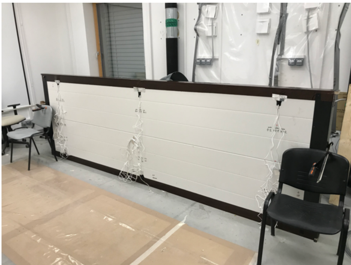
Joonis 2.7 Detailidest kokku monteeritud katsekeha, mida kuivatatakse seinamoniteeritult konvektsiooni teel
