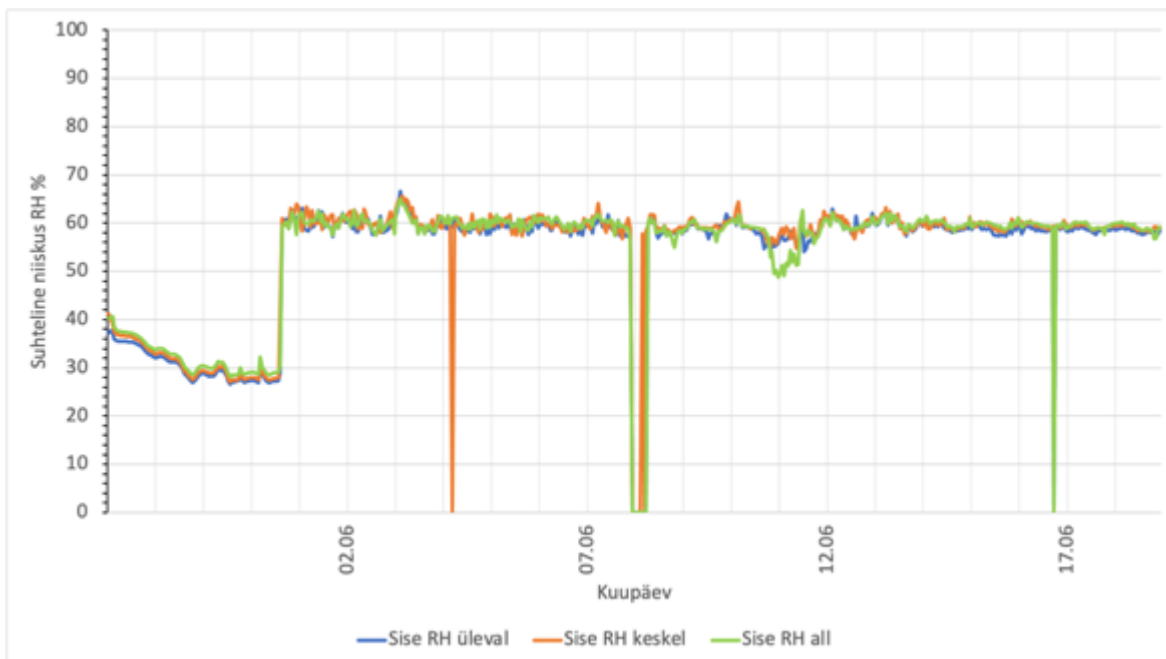
Joonis 3.18 Mõõdetud siseruumi suhteline niiskus erinevatel kõrgustel. Suhtelise niiskuse jaotus kõrguslikult on valdava osa ajast ühtlane
