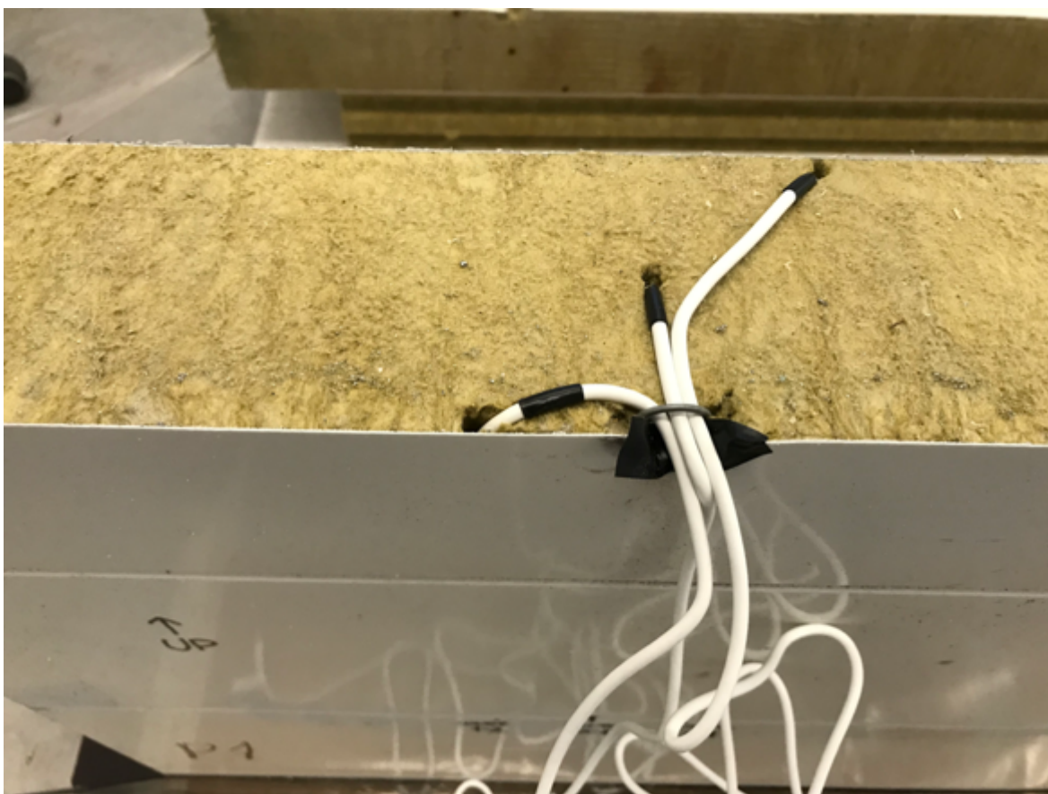
Joonis 2.6 Risti soojusvooga puuritud avadesse sisestatud andurid
