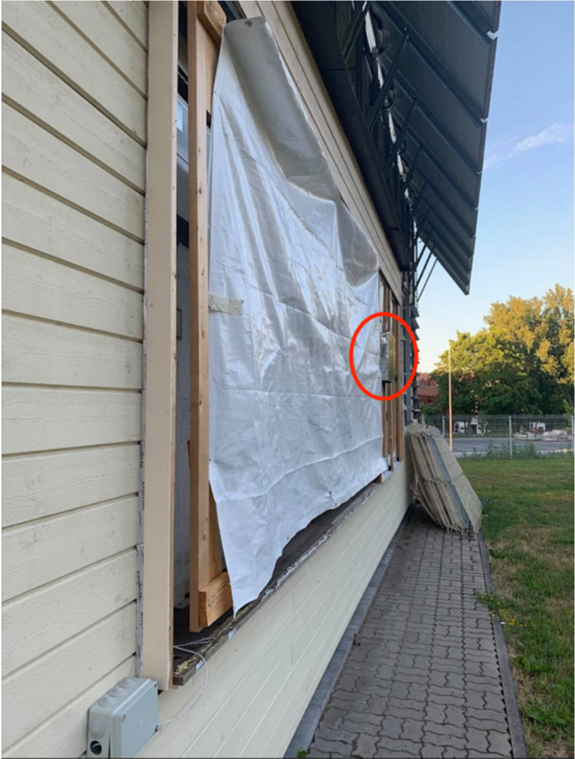
Joonis 2.14 Temperatuuri ja suhtelise niiskuse andurite asukoht välistingimuste mõõtmiseks.
