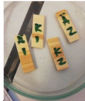
d - Hall-lepa niiskuse mõõtmiseks katsekehad Petri klaasil
