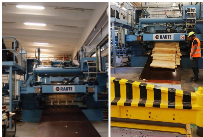
Joonis 1.1.1.1 TalTech'i Puidutehnoloogia labori spoonikoorimistreibipink Raute 3HV66 (vasakul) ja treitud spoon (paremal) [11]
