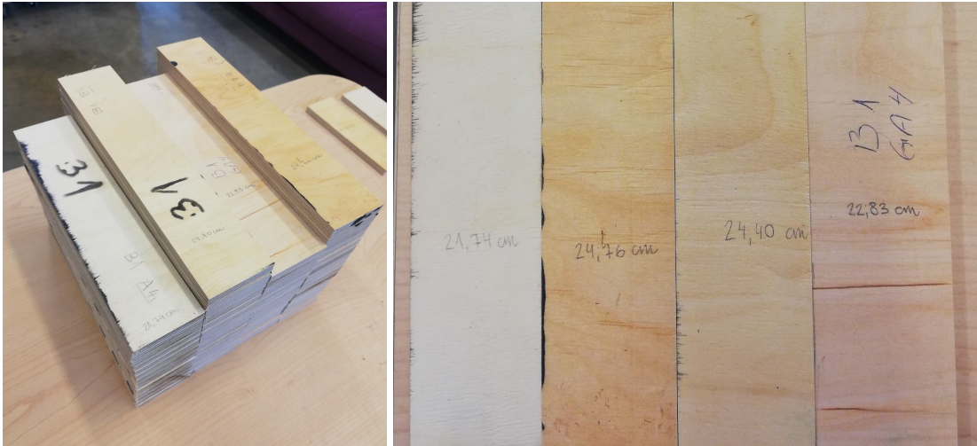
Joonis 2.5.1 Ühe surve jagu paindekatsekehad enne katseid (vasakul) ja katsekehade pikkuste erinevused (paremal)
