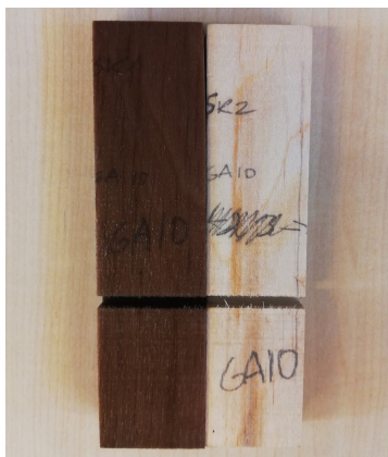
Joonis 2.4.1 Tõmbekatsekeha peale ettevalmistust vahetult enne katset (vasakul) ja tõmbekatsekeha enne ettevalmistust (paremal) hall-lepa näitel
