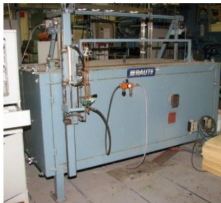
e - Raute spoonilehe kuivati (vasakul) ja kõik kuivatatud 420 lehte (paremal)
