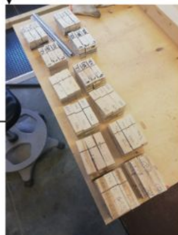
n - Märgistatud katsekehad (vasakul), 1/3 tõmbekatskehadedest (keskel) ja kõik tõmbe- ja paindekatskehade kokku (paremal)
