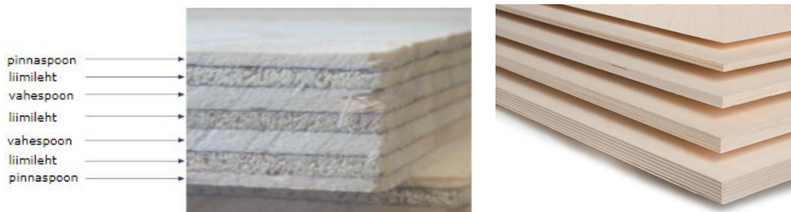
Joonis 1.1.2.1 Vineeriplaadi struktuur (vasakul) ja erinevate paksustega vineerplaatide näiteid (paremal) [16][17]
