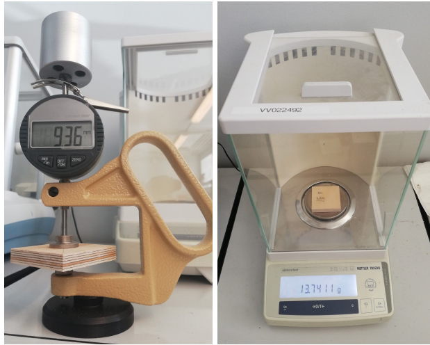
Joonis 2.6.2 Paksuse mõõtmine (vasakul) ja kaalumine (paremal) ja kõik katsekehad (paremal)
