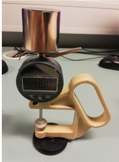
Joonis 2.3.1 Schmidt-i DMD-3-1 paksuse mõõtja
