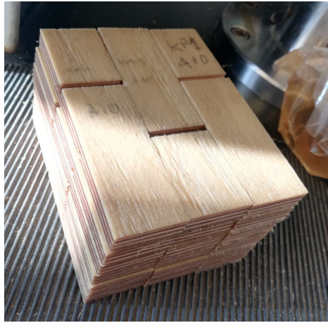
Joonis 2.4.3 Haava ühe plaadi jagu tõmbekatsekehasid enne katseid
