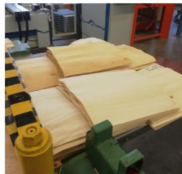
f - Sorteeritud spoonilehed kase ja haava näitel (vasakul) ning hall-lepa ja sanglepa näitel (paremal)
