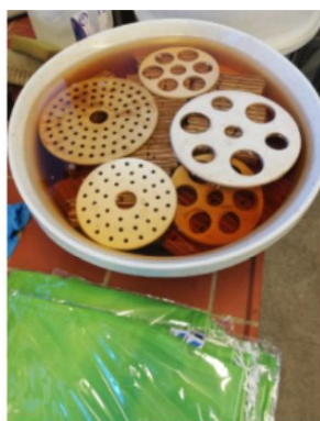
o - Tõmbekatskehade peale 24 h vees seismist (vasakul), katsekehad plaatide järgi jaotatult kottidesse (keskel) ja keemisvann (paremal)
