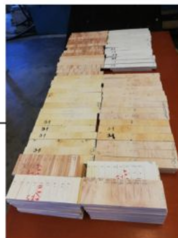
n - Märgistatud katsekehad (vasakul), 1/3 tõmbekatskehadedest (keskel) ja kõik tõmbe- ja paindekatskehade kokku (paremal)
