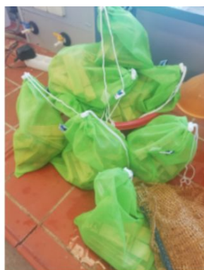
o - Tõmbekatskehade peale 24 h vees seismist (vasakul), katsekehad plaatide järgi jaotatult kottidesse (keskel) ja keemisvann (paremal)
