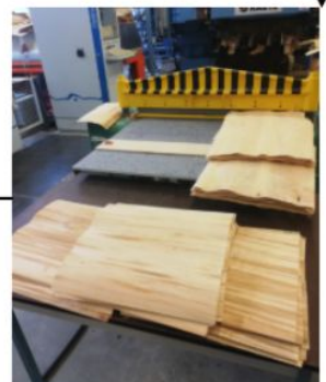
f - Sorteeritud spoonilehed kase ja haava näitel (vasakul) ning hall-lepa ja sanglepa näitel (paremal)
