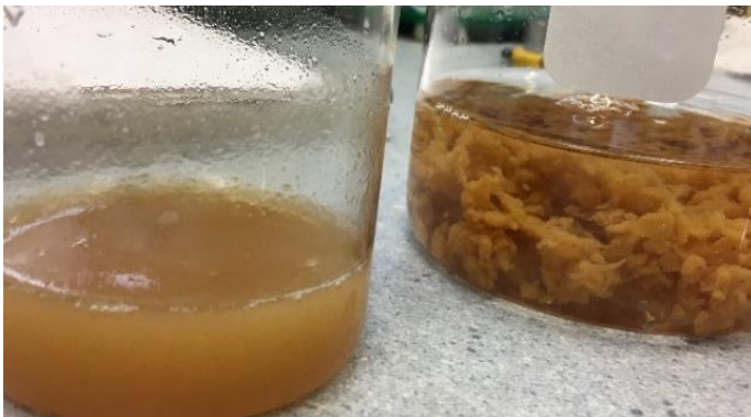
Joonis L1.8. Reoveesete tavaolekus (vasakul) ja polümeeriga segatuna (paremal) (autori foto)
