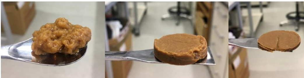
Joonis L1.9. Pressikats 3 etappi (vasakult: sete enne katseseadmesse minekut, pärast I pressimist, pärast II pressimist) (autori foto)
