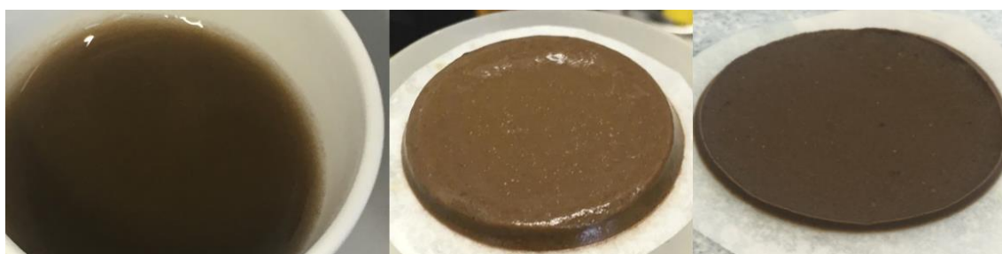
Joonis 3.1. Reoveesette vedel, pooltahke ja tahkema konsistentsiga proov (autori foto)
