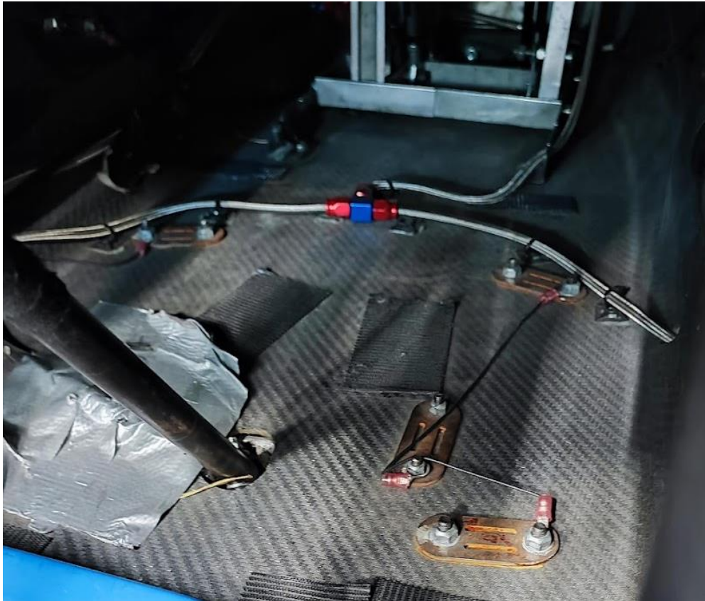
Joonis 7.1 FEST17 maandus kaabelkingadega roolilatikinnitus ja esimesed alumised õõtshoovad
