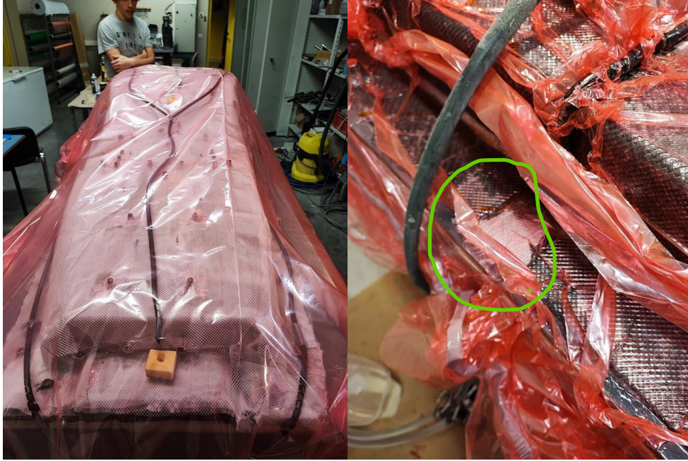
Joonis 4.1 Kerevormide sööt ja äratõmbe torud A osa , kuivaks jäänud koht B osa
