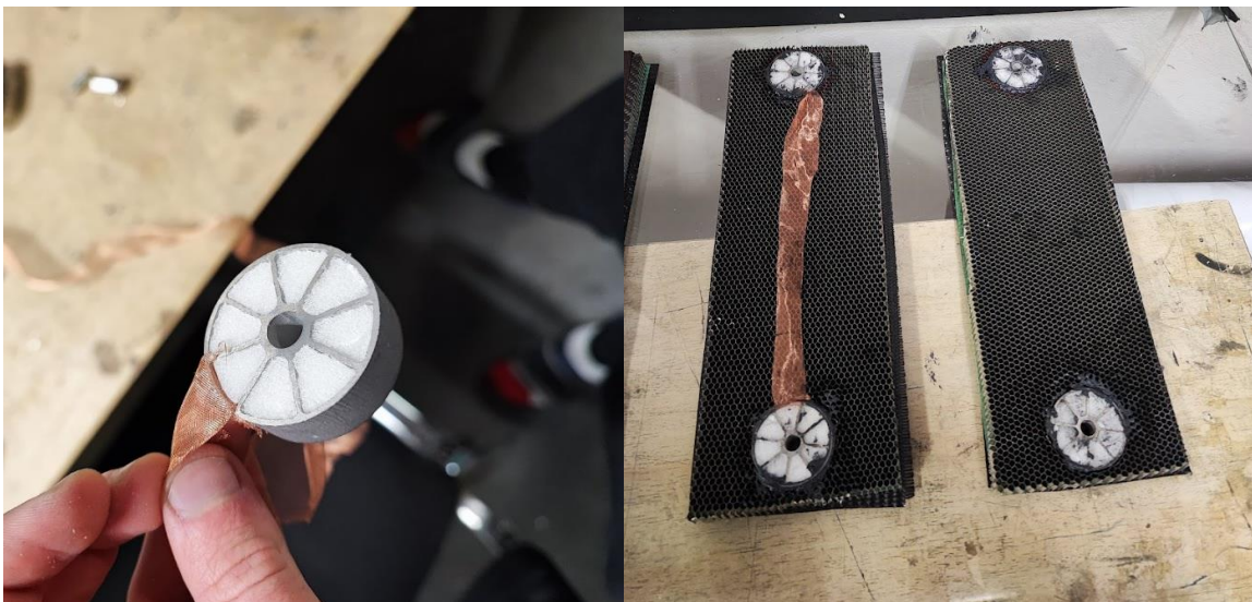
Joonis 5.3 A osa: Vaskkangas pukside vahel B osa: pukside asetus laminaadis ja pasta kasutus
