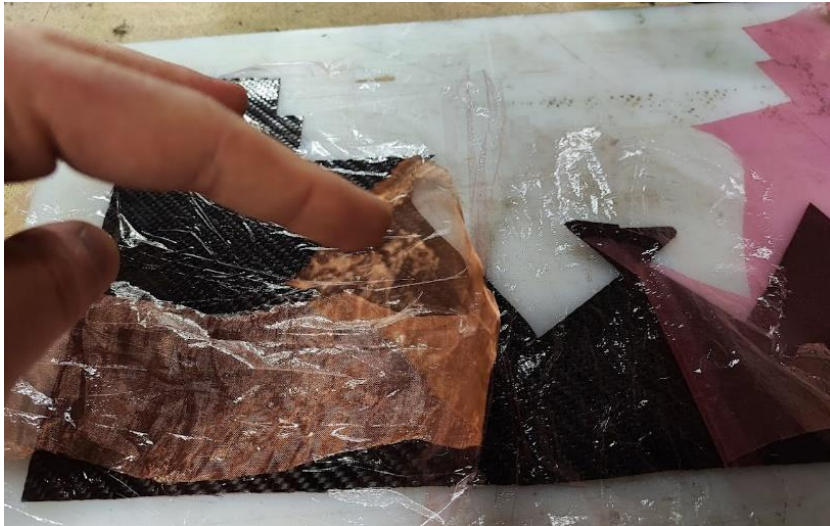
Joonis 8.3 Vaskkanga väljatoomist laminaadi keskel selgitav joonis
