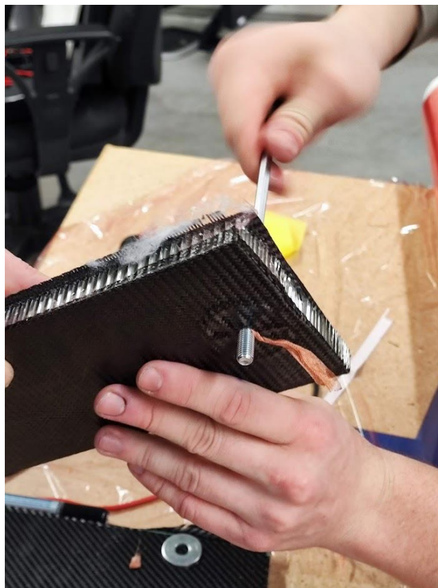
Joonis 5.4. Poldi avadesse pandud lisavõrk parema poldi kontakti saamiseks puksiga
