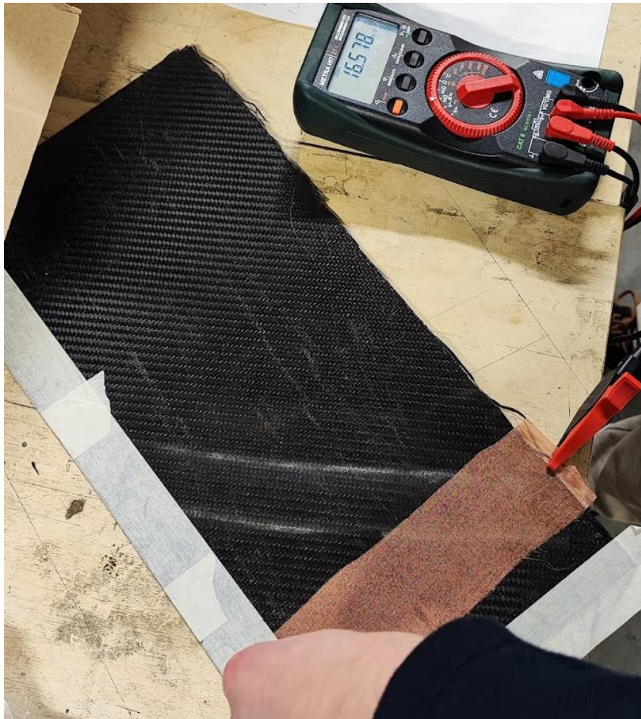
Joonis 5.5. Märjalt süsiniku peale lamineeritud esimese kihi mõõte tulemus
