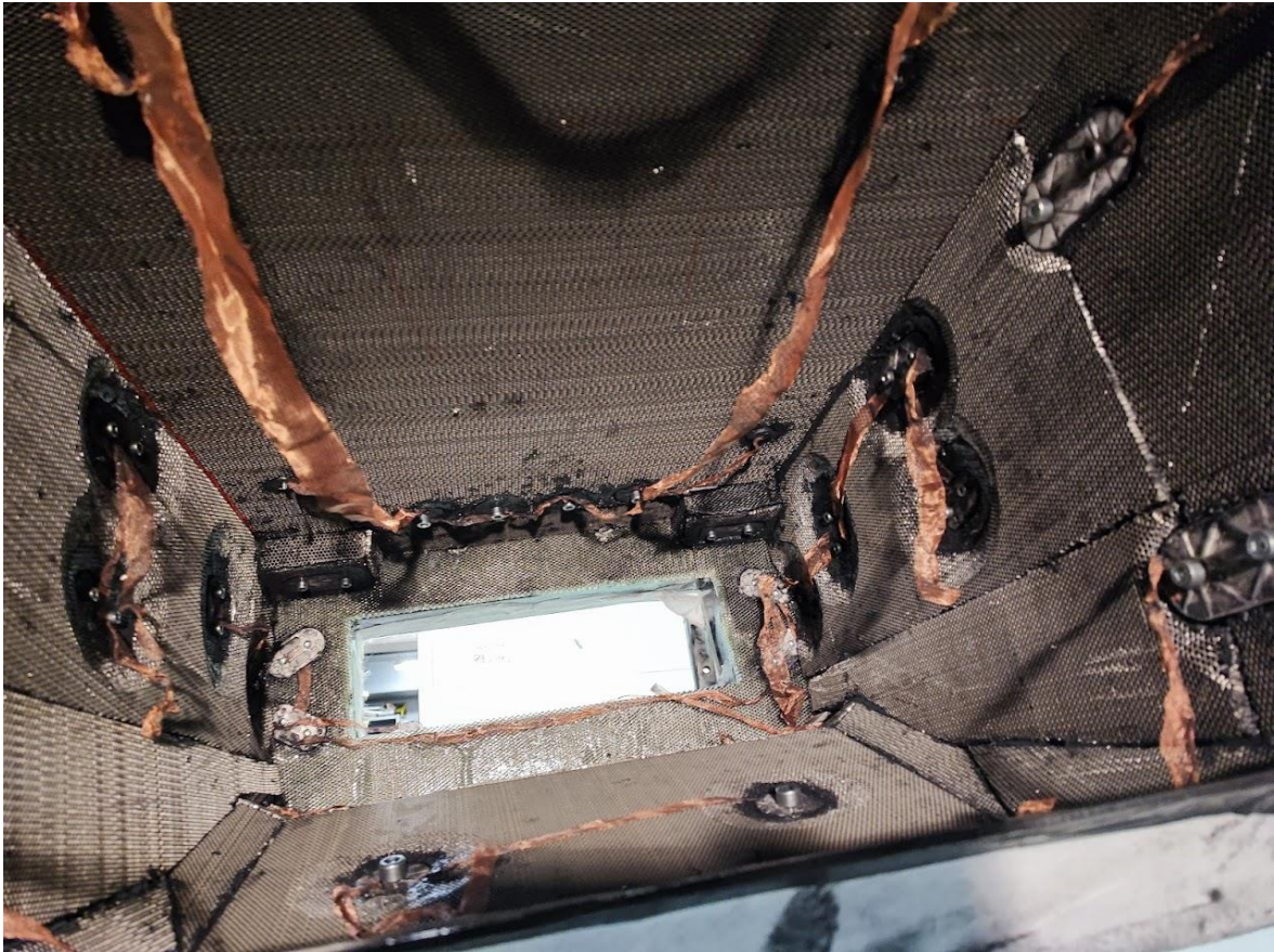
Joonis 6.2 Vaskkangas kerevormis ühendatud ja rippumas enne viimast süsiniku kihti
