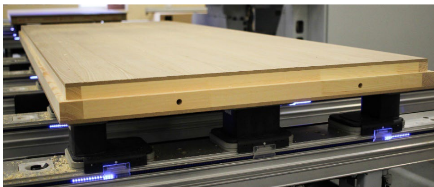
Joonis 7.38 Vaakumtald koos konsoolil olevate LED-tuledega (markeerivad sobiva koha, mis oleks löiketsoonist eemal).
