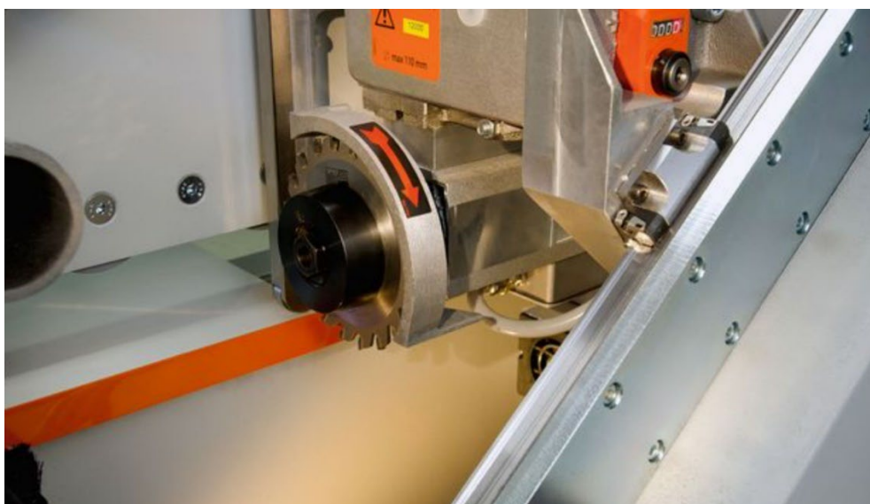
Joonis 6.17 Servapealistusmaterjali pikkuse ülemõõdu eemaldamine otsalõikesaega. Foto: HOLZ-HER GmbH
