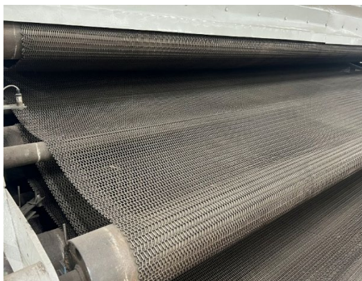
Joonis 3.39 Võrkkuivati transportvõrgud ilma spoonita (vasakul) ja spooniga (paremal). Fotod: Balti Spoon OÜ ja UPM-Kymmene Otepää OÜ
