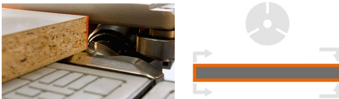
Joonis 6.19 Korduvtöötlusagregaadi frees ja selle liikumine. Foto: HOLZ-HER GmbH
