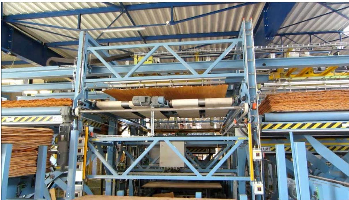
Joonis 5.73 Spoonide automaatne etteandmine vineeritooriku koostamisliinil. Allikas: Raute Oyj
