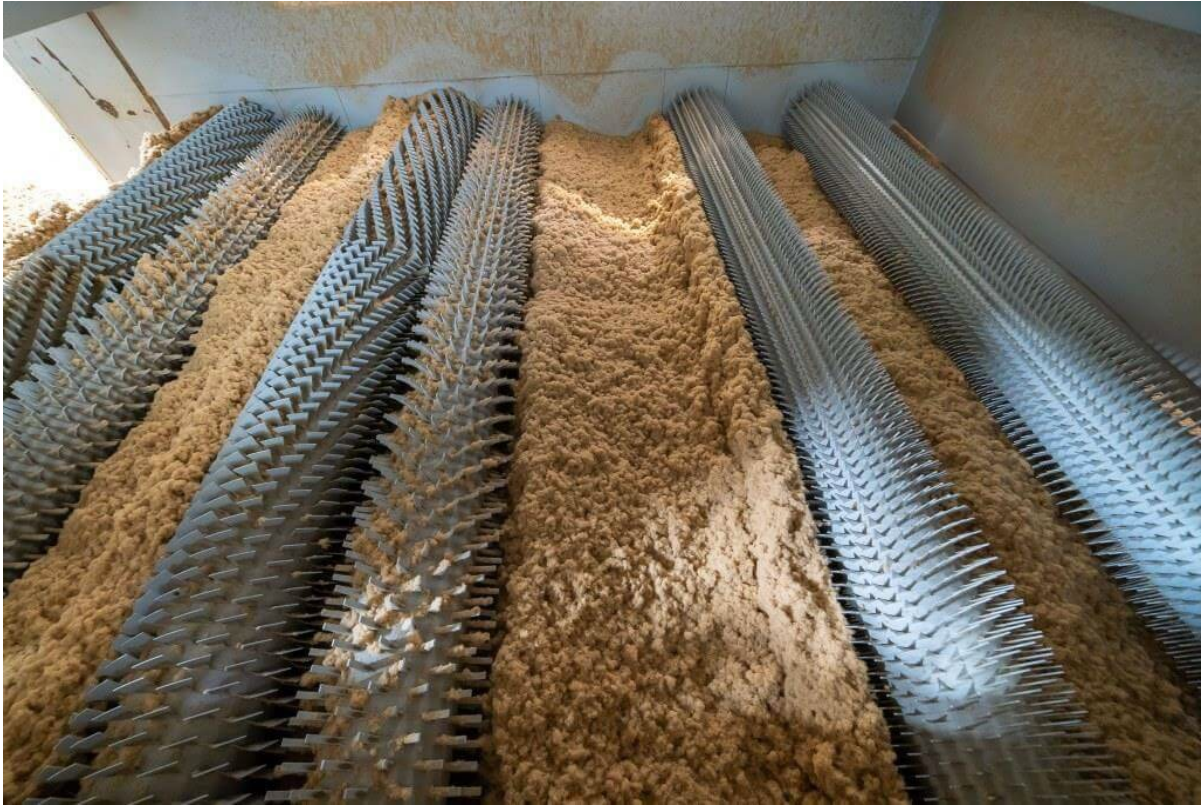
Joonis 5.98 MDF-plaadi kiupunker sissevaade (ribivaltsid kiumassi ühtlustamiseks). Foto: G. Siempelkamp GmbH & Co. KG
