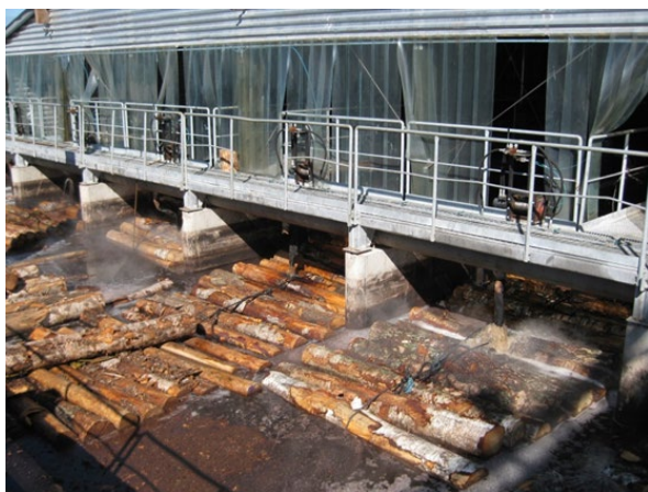
Joonis 2.57 Palkide vihmutamine ujuvpalkidega basseinis. Foto: Raute OYj
