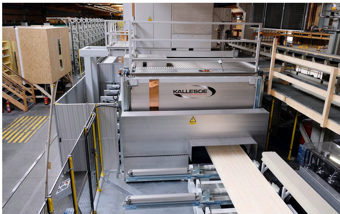
Joonis 5.21 Kõrgsageduspress. Foto: JS Inseneribüroo OÜ
