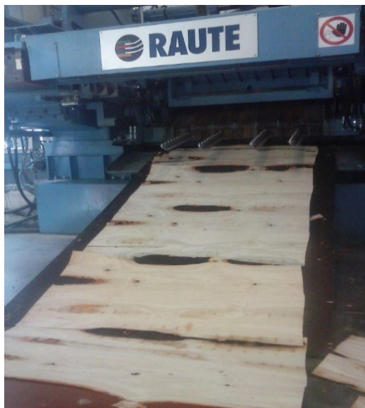
Joonis 5.46 Treimisel tekkiv ebaühtlane spoon.
