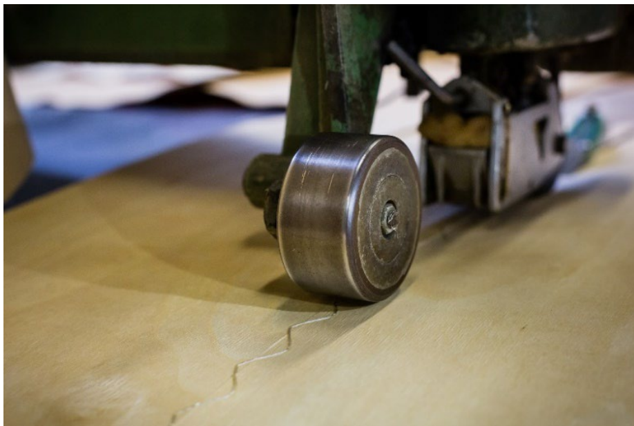
Joonis 6.30 Spooniribade ühendamine siksak-meetodil. Foto: Tarmeko AS
