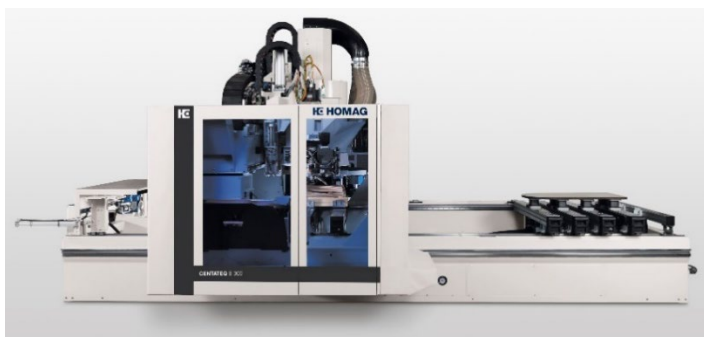
Joonis 7.29 Rasterlauaga nesting -CNC-töötlemiskeskus ja näide võimalikust töödeldavast detailist. Foto: HOMAG Group AG, joonis: K. Kiiman
