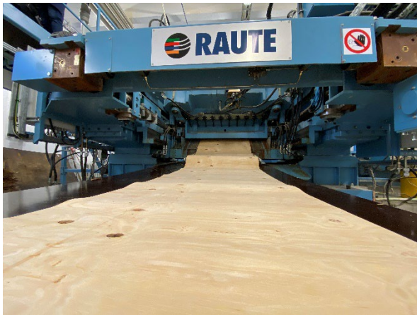
Joonis 2.73 Spoonitreipingist spoonimati väljatulek.
