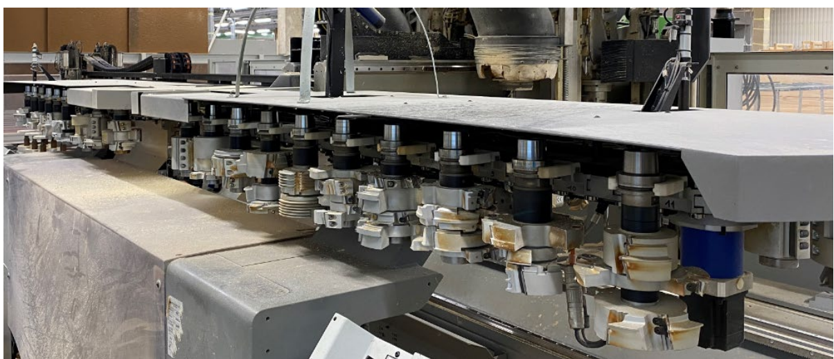
Joonis 7.56 Kaks 22-kohalist kettkaruselli, üks kummalegi 19 kW peamootorile.
