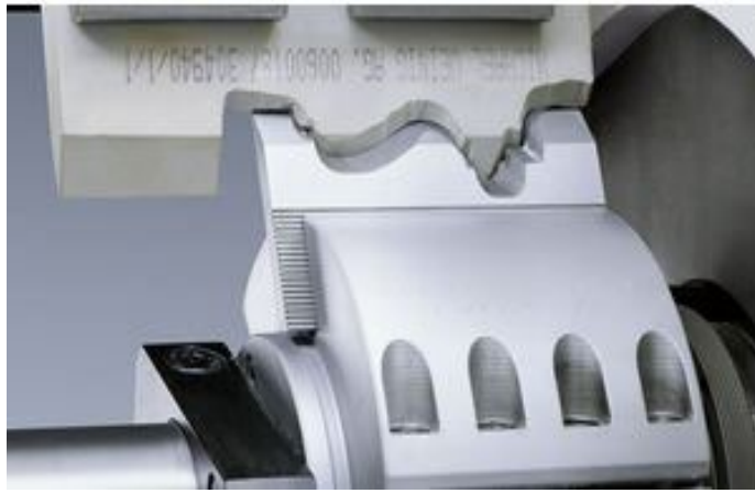
Joonis 1.78 Nugade pöörlemisraadiuste ühtlustamine profiilluisu abil. Foto: Michael Weinig AG
