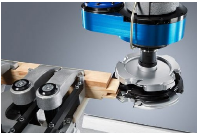
Joonis 7.52 Klassikalise tappühenduse töötlemine.
