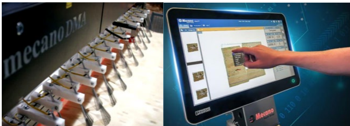
Joonis 3.45 Spooni niiskuse automaatkontrollisüsteem. Allikas: Raute Oyj
