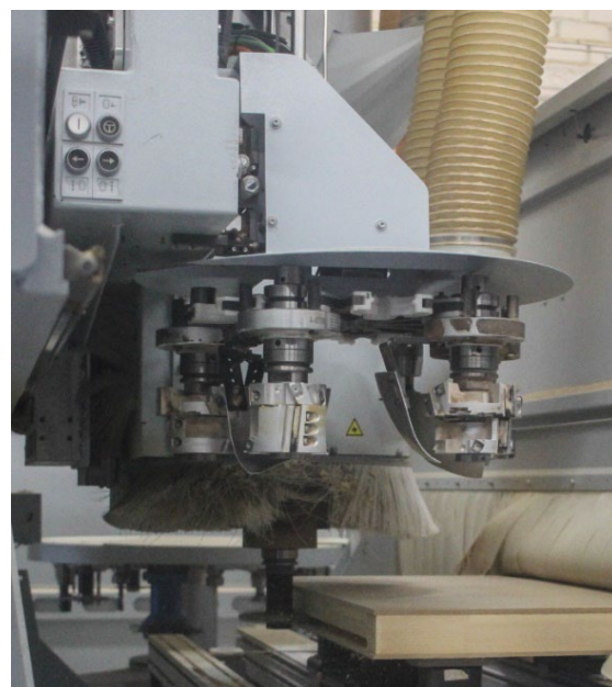
Joonis 7.36 Tööriistakarusell laastusuunajatega varustatud profiilfreesidega.
