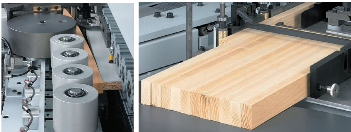
Joonis 6.16 Surverullid ja krepri etteanne. Foto: HOMAG Group AG
