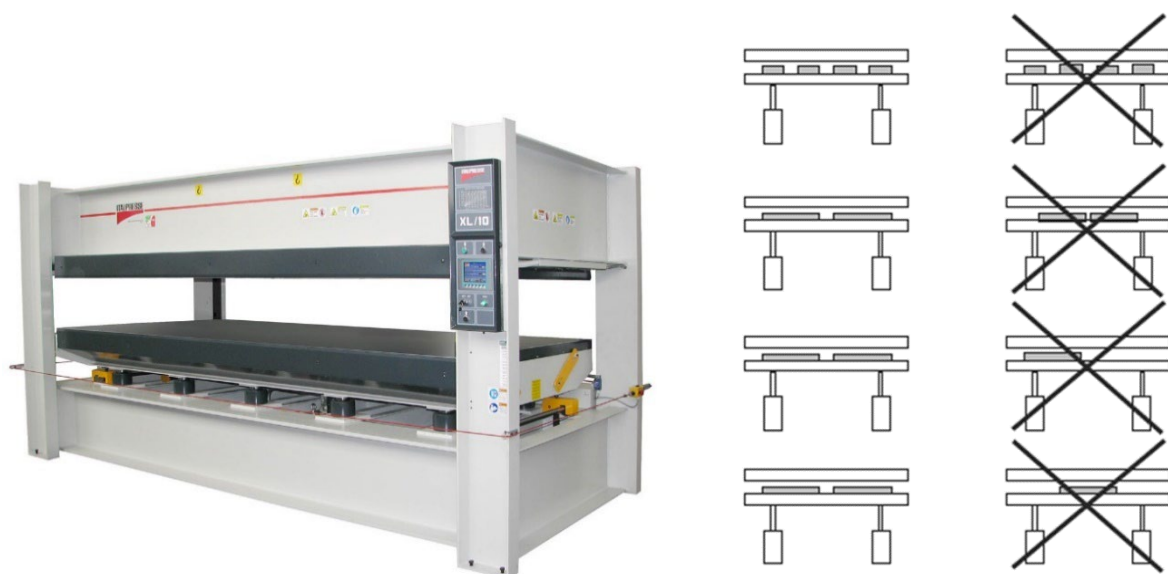
Joonis 6.27 Ühevaheline hüdrauliline kuumpress ja detailide paigutamine pressi. Foto: ITALPRESSE S.P.A.
