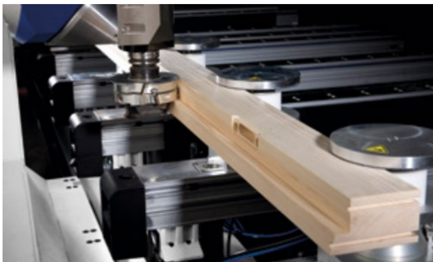
Joonis 7.39 Suruõhuklambrid raamukse detaili profileerimisel.
