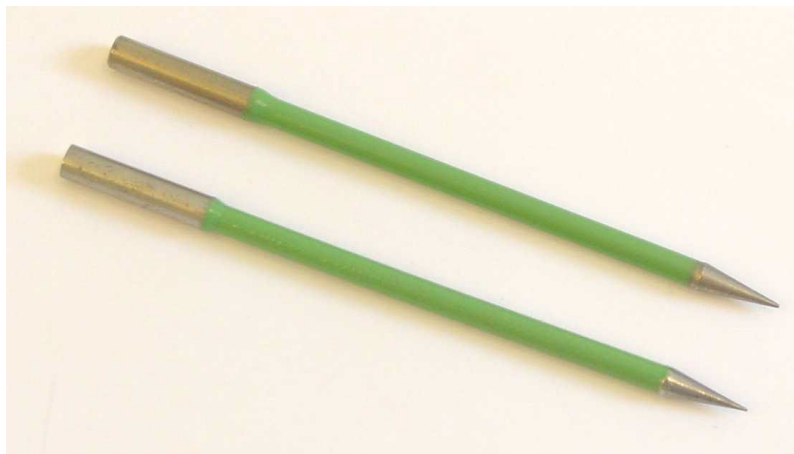
Joonis 5.37 Isoleeritud mõõtenõelad. Foto: JS Inseneribüroo OÜ
