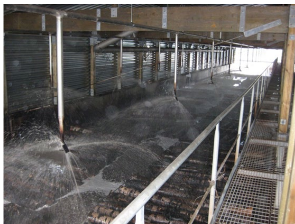
Joonis 2.57 Palkide vihmutamine ujuvpalkidega basseinis. Foto: Raute OYj
