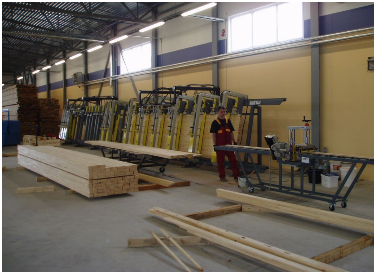
Joonis 5.8 Liimivaltsid (paremal) ja seinapress (vasakul). Foto: JS Inseneribüroo OÜ
