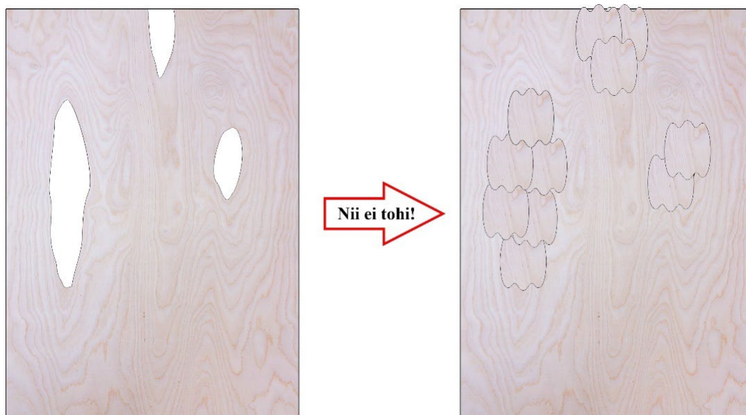
Joonis 5.61 Spoonipaikade vale paigutus.
