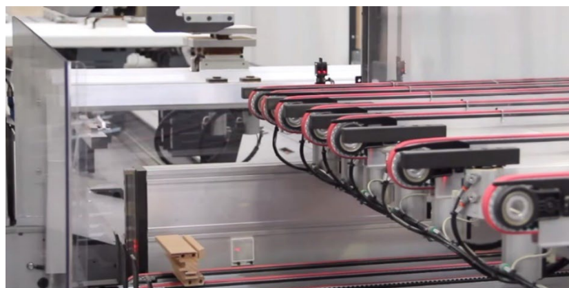
Joonis 7.68 Etteande- ja väljalaadimiskonveieri paiknemine (teineteise all, ergonoomiliselt samas töötsoonis).
