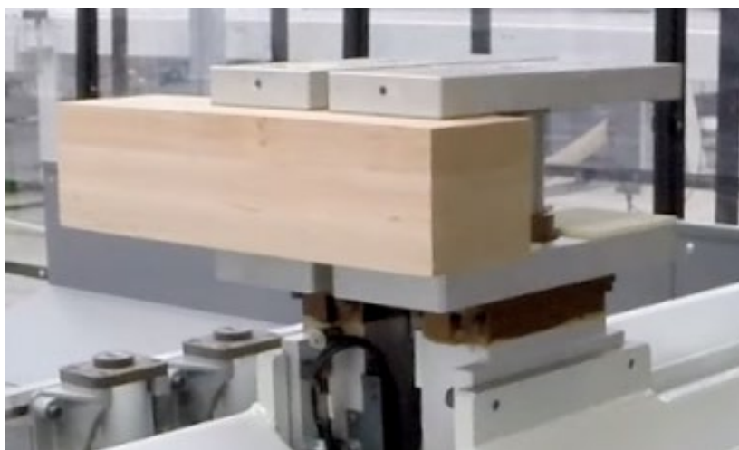
Joonis 7.53 Lühikese detaili fikseerimine kahe klambriga.
