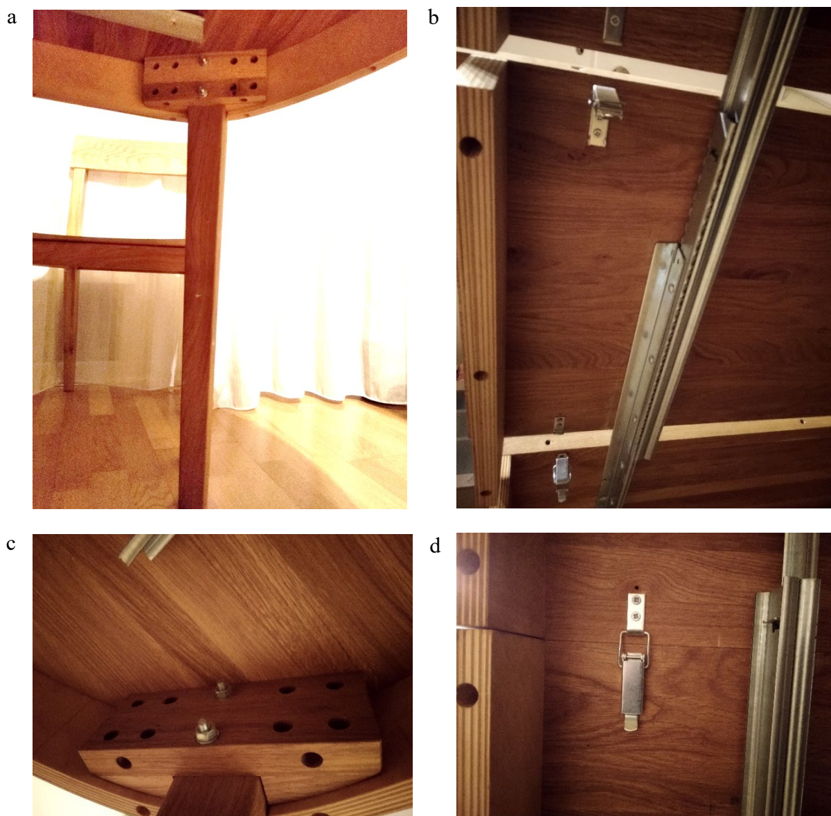
Joonis 9.84 Pikendatav söögilaud siinide ja kinnitusklambritega: a – lauajalg, c – lauajala kinnitus tikkpoltide, mutrite ja puidukruvidega, b – siinid söögilaua pikendamiseks ja d – plaate ühendav kinnitusklamber.
