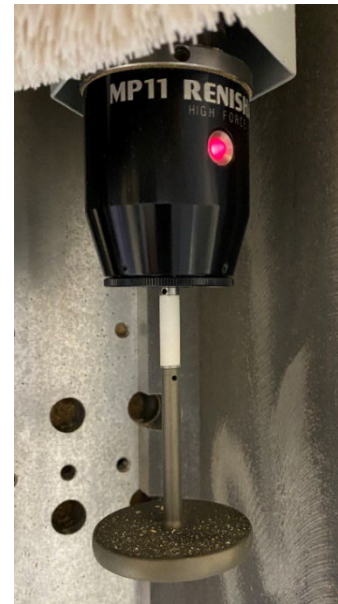
Joonis 7.44 Peamootori kõrval asuv mõõteandur.
