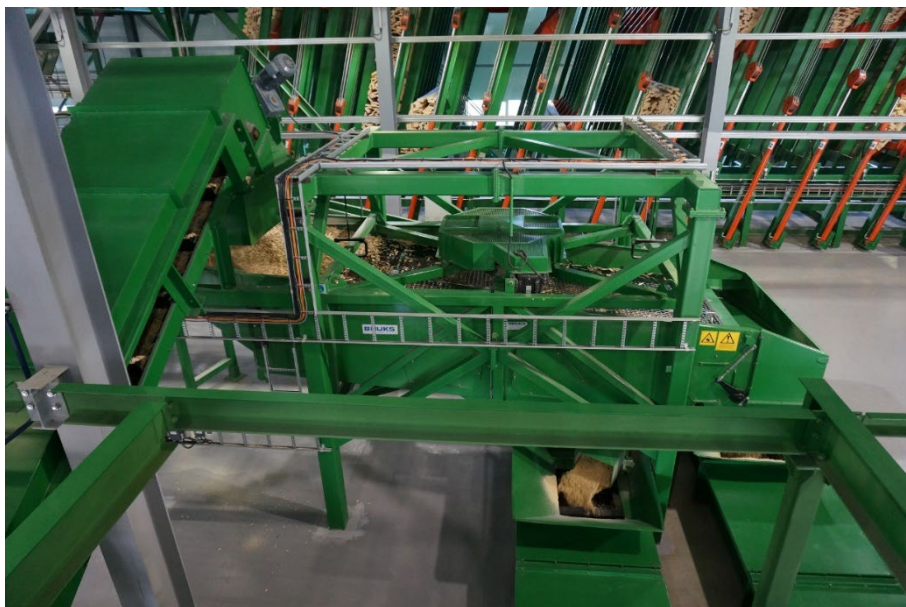
Joonis 2.36 Laastu sõelumine peenfraktsiooni ja saepuru eraldamine sellest. Foto: AS Hekotek
