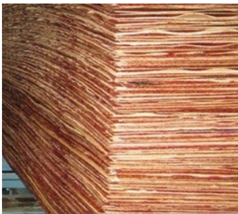
Joonis 5.70 Spoonid on laotatud vineeritoorikuks vastu külgsuunajad. Allikas: Raute Oyj
