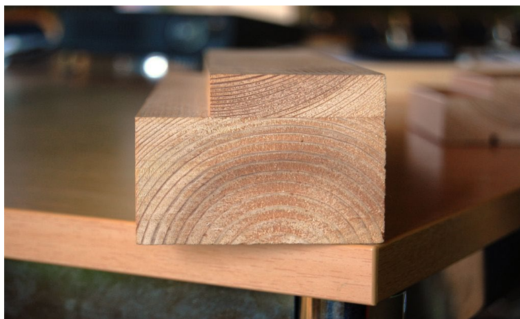
Joonis 4.29 Kahe laiuse ja paksusega sõrmjätkatud tooriku kokkuliimimine Foto: M. Riistop
