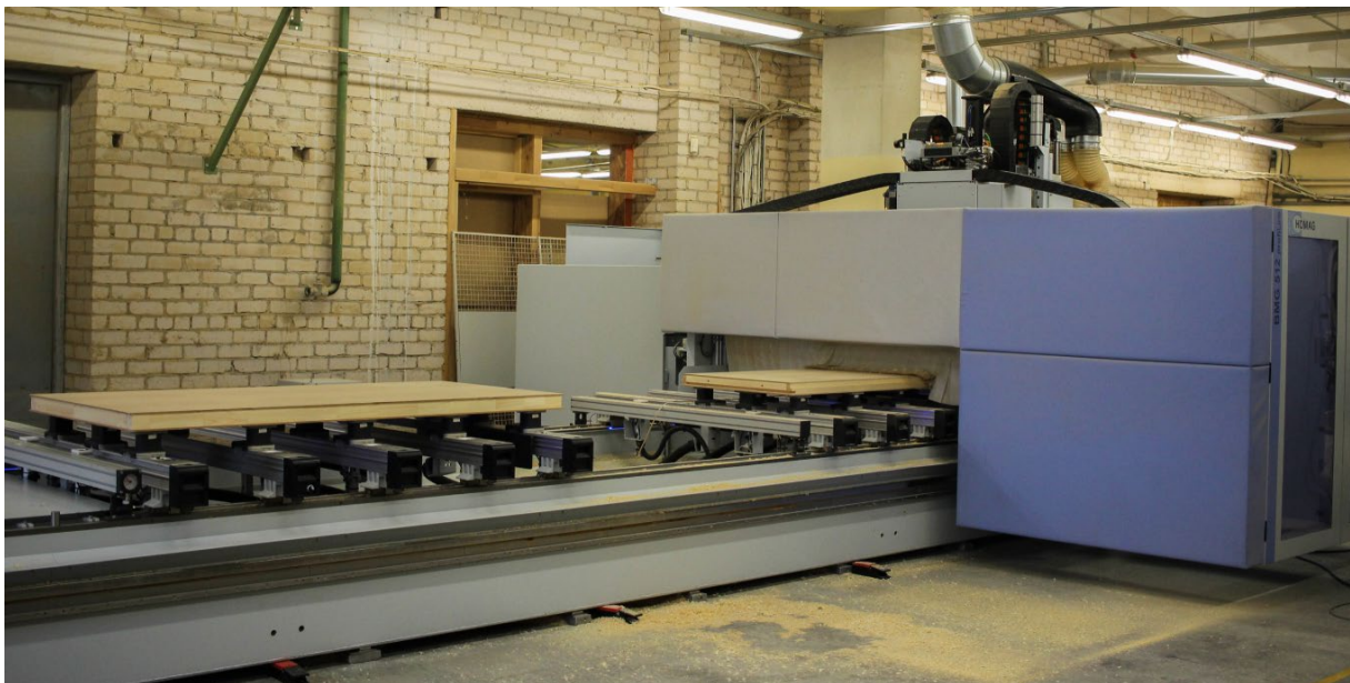
Joonis 7.32 Pendellauaga portaalpink SORB TECH tehnoloogiaga valatud 9 t kerega, liikuva suporti kaal 3 t.
