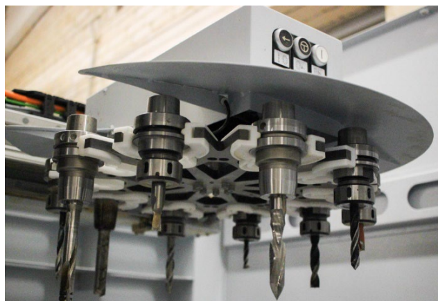
Joonis 7.35 Kümnekohaline tööriistakarusell erinevate puuride ja sõrmfreesidega.
