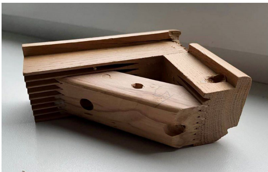
Joonis 4.32 Sõrmjätku kasutamine nurkliites puittoolide konstruktsioonis.
