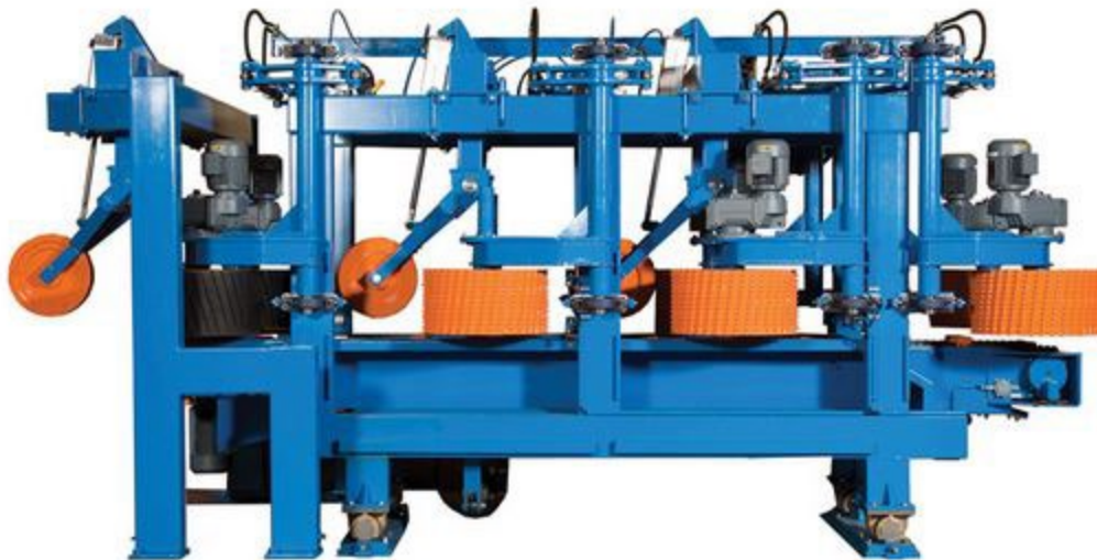
Joonis 2.32 Seade palkide positsioneerimiseks saeliinile andmisel. Foto: USNR AB
