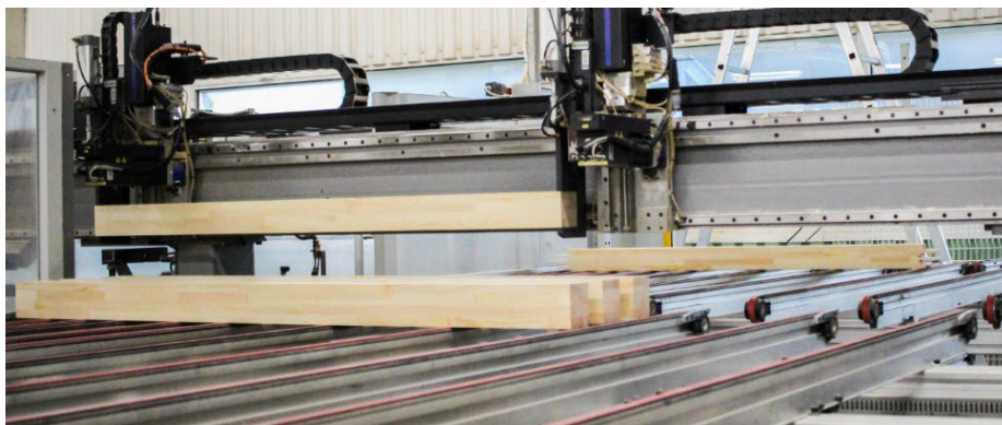
Joonis 7.60 Etteandekonveier ja manipulaatorid, mis toimetavad detaili töötlemistsooni.
