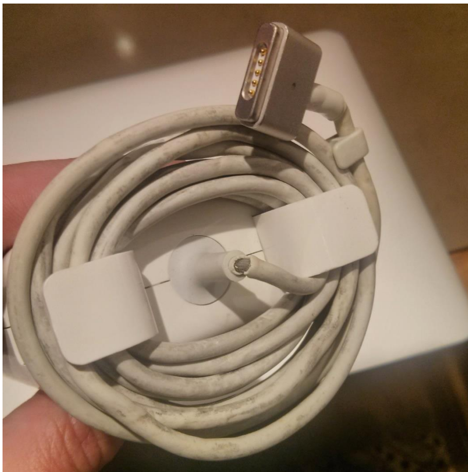
Joonis 2.2 Koos kõrvadega MagSafe 2 laadija kaabli vigastusega [7]
