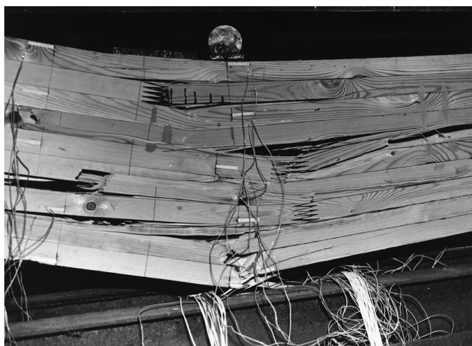
DFK-liimiga valmistatud puittala katsetamine.
