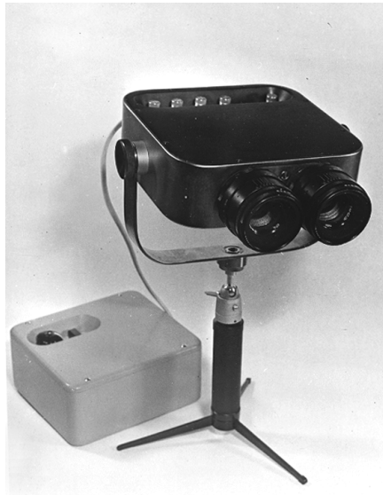
Portatiivne lasersidesüsteem, mida on demonstreeritud näitustel 12 riigis.
