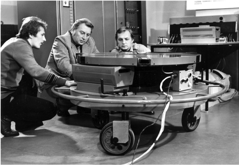
Linearmootoritega röntgenkontrolli pöördlaud. Vasakult Leo Karafin, Juhan Laugis ja Aivar Reivik.
