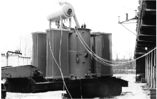
Esimese Eestis leiutatud juhitava reaktori aktiivosa ja reaktori katsetamine Ellamaa alajaamas 1980. aastal.
