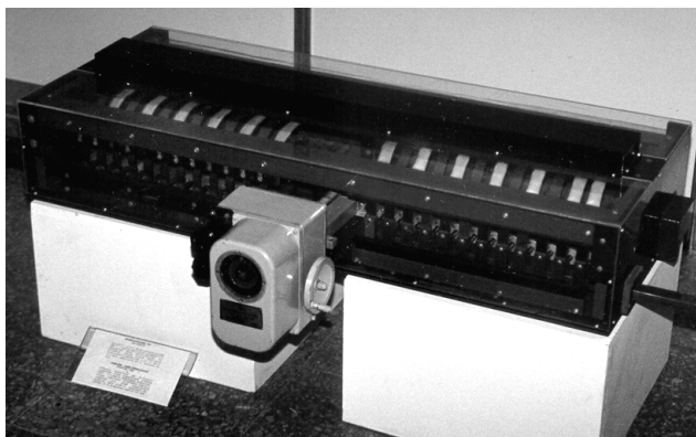
Automaatse 12-astmelise kondensaatorpatarei teenindava türistorlüliiti valijalüliiti, nimivool I = 1 \text{ kA} , pingeline U = 380 \text{ V} .
