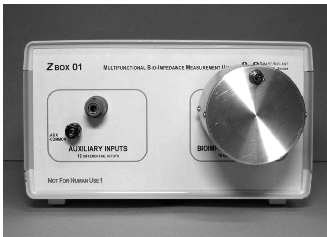
Ekspereimantaalne bioimpedantsi mõõtur ja analüsaator, projekteeritud USA kontserni Guidant (praegu Boston Scientific Inc.) eritellimusel kardiovaskulaarseteks uuringuteks loomkatsete juures.
