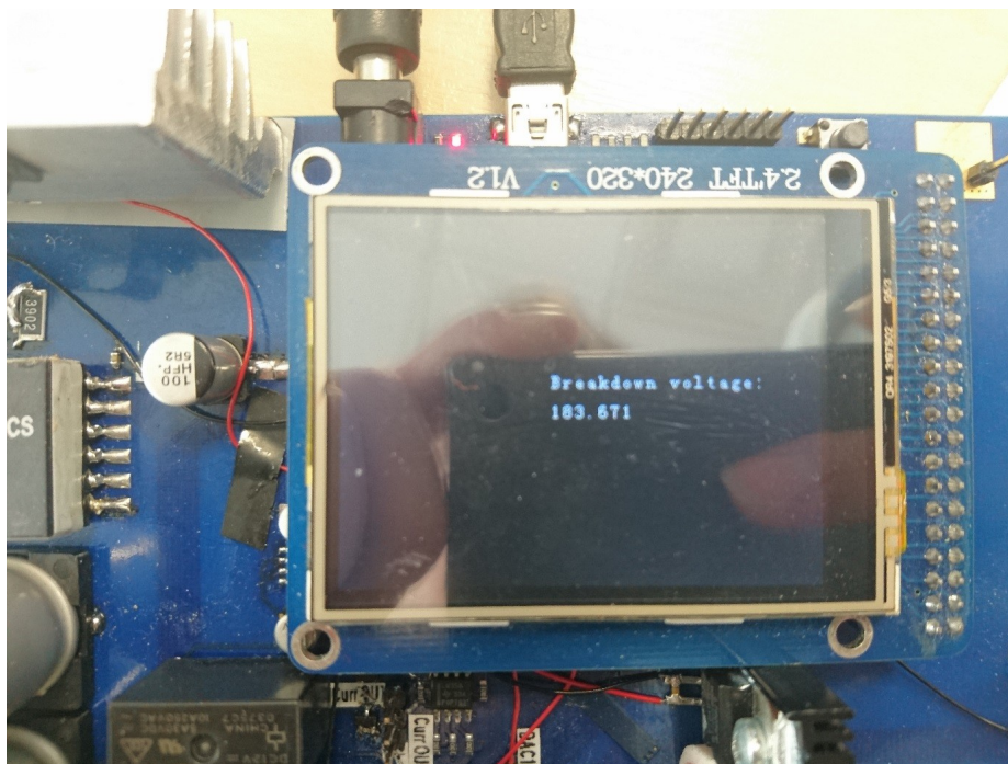
Joonis 25. Zener diodi 1N5956BRLG kiirtesti tulemus esitatud tekstina seadme ekraanil.
