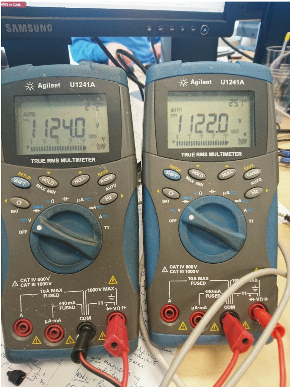
Joonis 24. Kahe multimeetriga väljundpinge mõõtmine.
