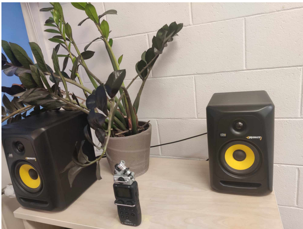
Joonis 2: Kõlarid on paigutatud ebasümmeetriliselt garanteerimaks, et vasaku ja parema kanali impulssvastused erinevad üksteisest piisavalt. See võimaldab adekvaatsemalt hinnata lahenduse stereoskoopilisi mõjusid
