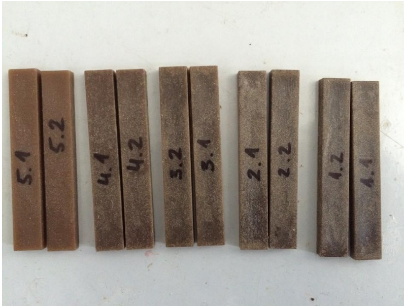
Joonis 9. Erineva puidujahu osakaaluga katsekehad (5-10% puidujahu, 4-20% puidujahu, 3-30% puidujahu, 2-35% puidujahu ja 1-40% puidujahu)
