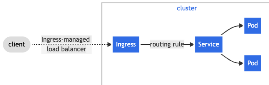
Joonis 7. Sissepääsu visuaalne näide [8]
