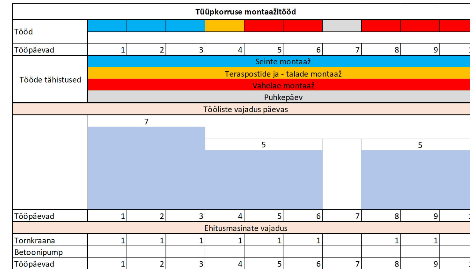
Tüüpkorruse montaažitööde kalendergraafil
