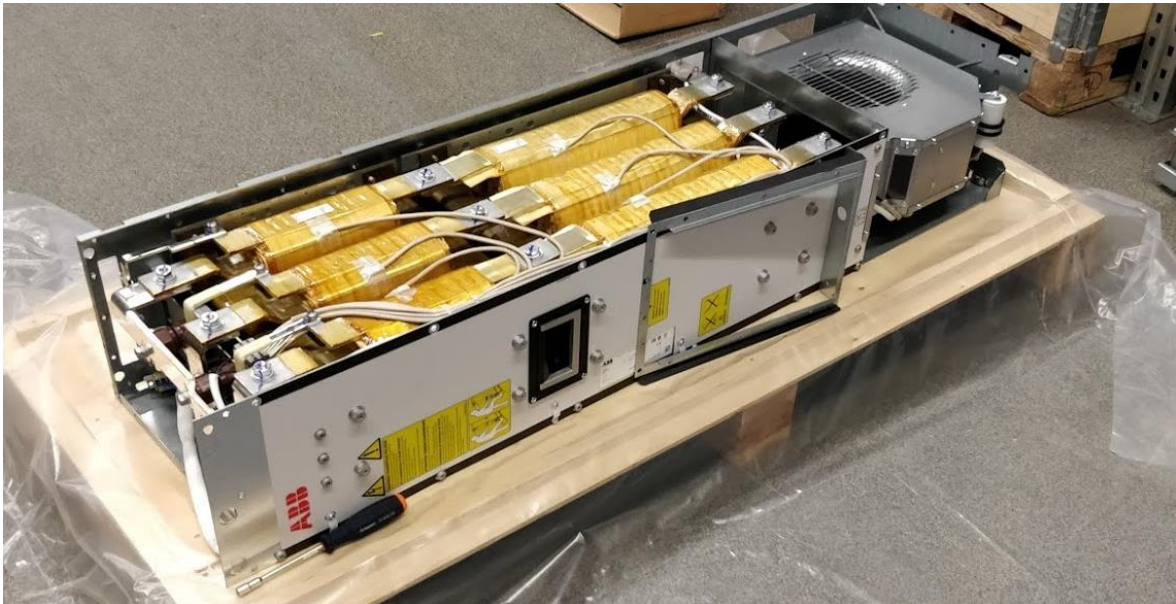
Joonis 3.3 1X moodul ilma pealmise küljekaaneta, paispoolide pakid nähtaval
