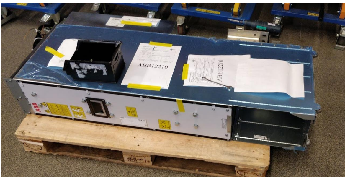
Joonis 3.2 Ventilaatorita 2X filtermoodul külili asendis, esialgne disain
