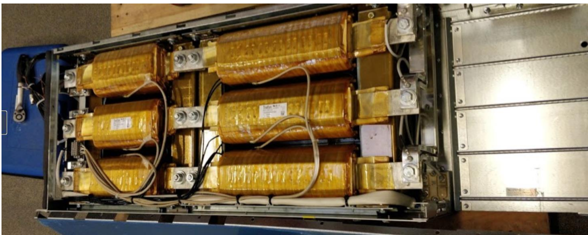
Joonis 3.4 2X moodul ilma pealmise küljekaaneta, paispoolide pakid nähtaval
