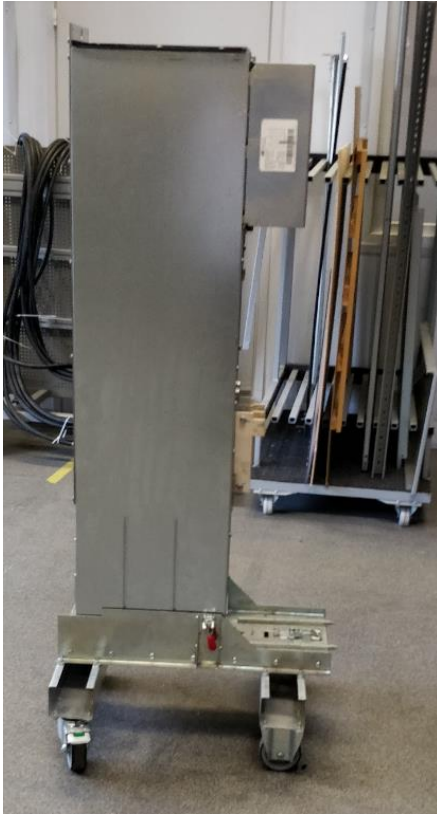
Joonis 9.2 Peaaegu ümber kukkunud 1X moodul ja ohuolukorra põhjustanud väiketarvik
