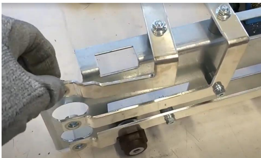
Joonis 7.3 Esialgne 2X mooduli W-faasi kondensaatori voolulati disain
