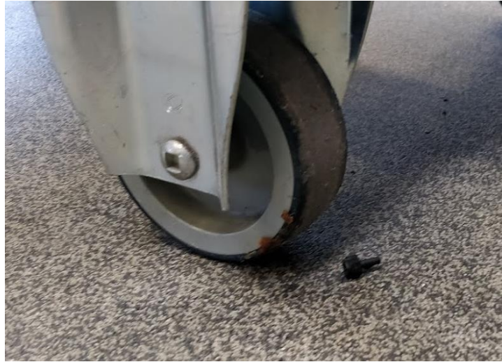
Joonis 9.2 Peaaegu ümber kukkunud 1X moodul ja ohuolukorra põhjustanud väiketarvik
