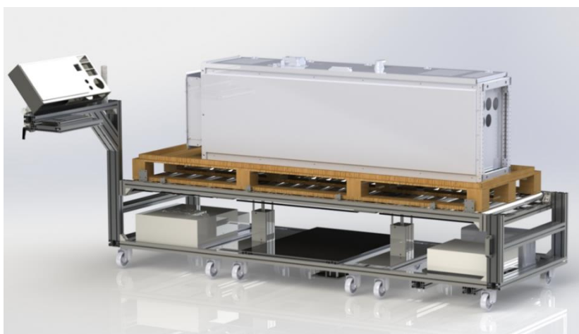
Joonis 3.8 Testsüsteemi raam ja ACX580-07 testimisasendis
