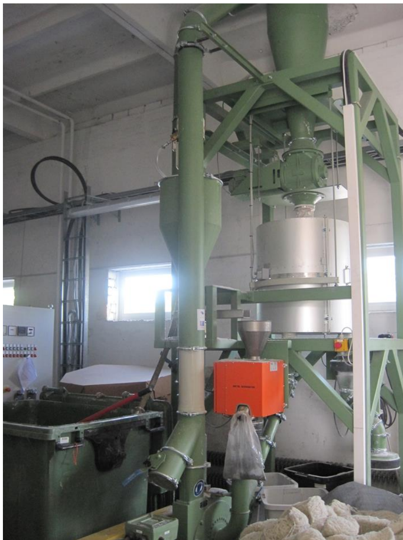
Joonis 22 Plasti purustamise masin (autori foto)
