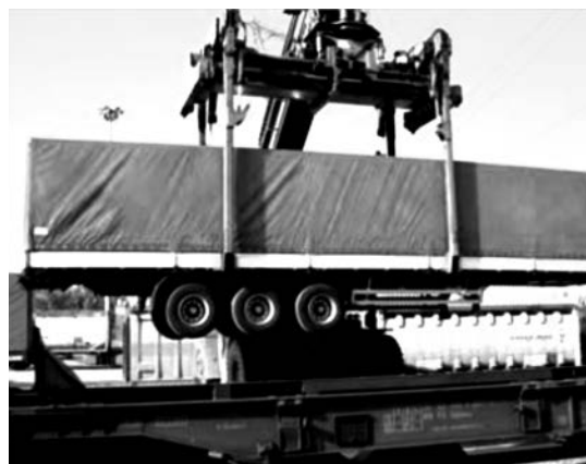
Joonis 10. Poolhaake tõstmine raudteeplatvormile
