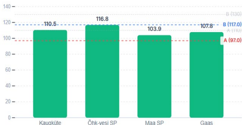
Joonis 7. Korteralamu ETA tulemused erinevate soojusallikate korral elektri kaalumisteguri alandamisel (2,0 -> 1,6) ning võimaliku piirmäärade alandamise variandina.
