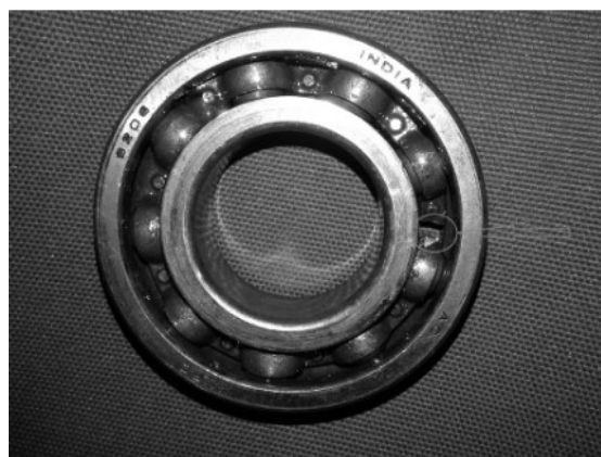
Joonis 3.1 Purunenud separaatoriga kuullaager [12]
