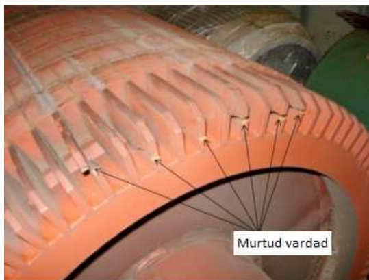
Joonis 3.5 Lühisrootori purunenud vardad [10]
