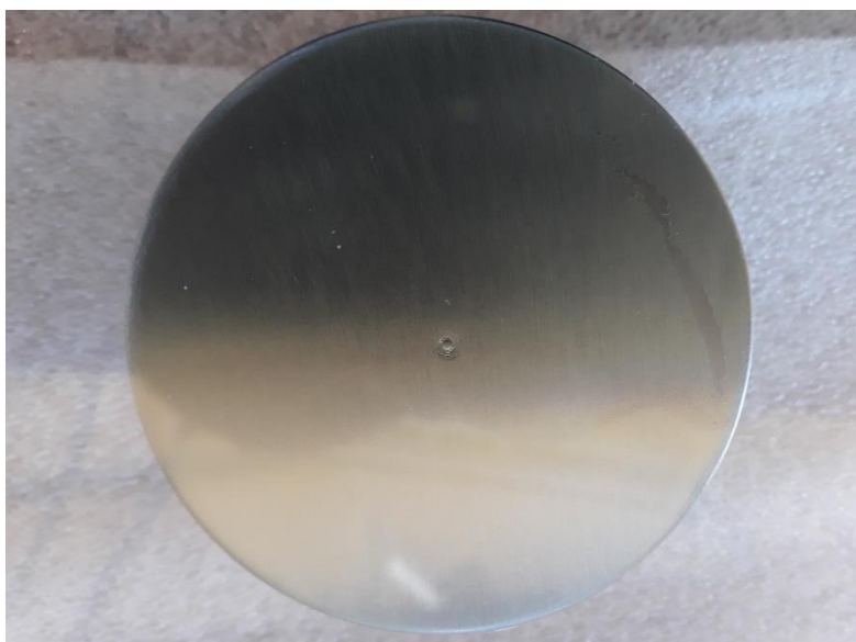
Joonis 3.4 Liimimise defekt
