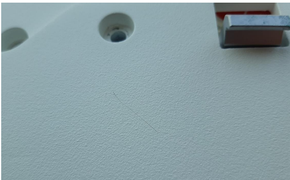
Joonis 3.5 Visuaalsel värvitud pinnal kriim
