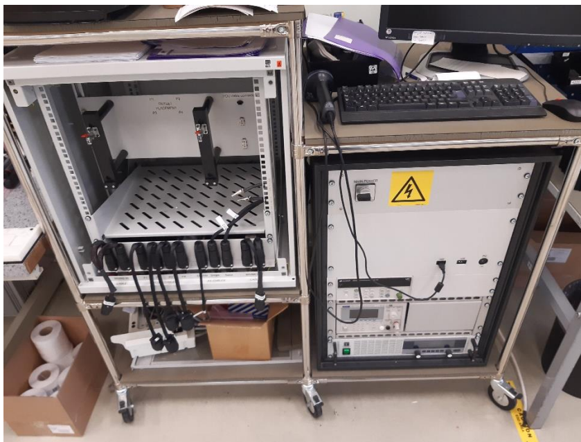
Joonis 4.2 Kaitsmete testimiseks kasutatav seade
