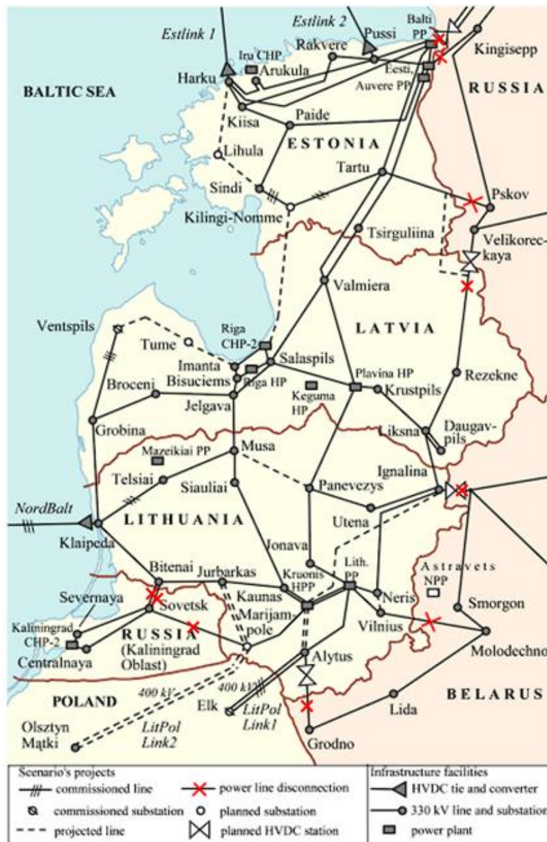
Joonis 1.6. Baltikumi elektrivõrgud. Antud joonis on koostatud 2016. aastal, mistõttu on näha planeeritavaid projekte, mis on lähiaastatel tühistatud (nt HVDC ühendused Venemaaga). Katkestatud ühendused (märgitud punase ristiga) on reaalsed [18]
