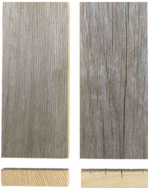
Joonis 7. Radiaalselt (vasakpoolne) ja tangentsiaalselt (parempoolne) saetud puitlaudis pärast 33-kuud väliskeskkonnas [22]
