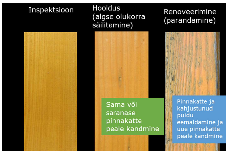
Joonis 5 Poolläbipaistva pinnakatte hooldusvajaduse staadiumid [14]
