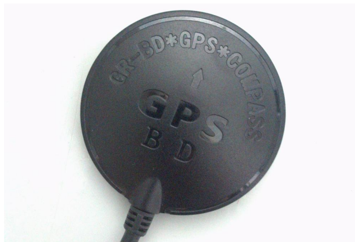
Joonis 2.5 Korpuse ja ühendusjuhtmetega GNSS moodul prototüüpmudeli jaoks.
