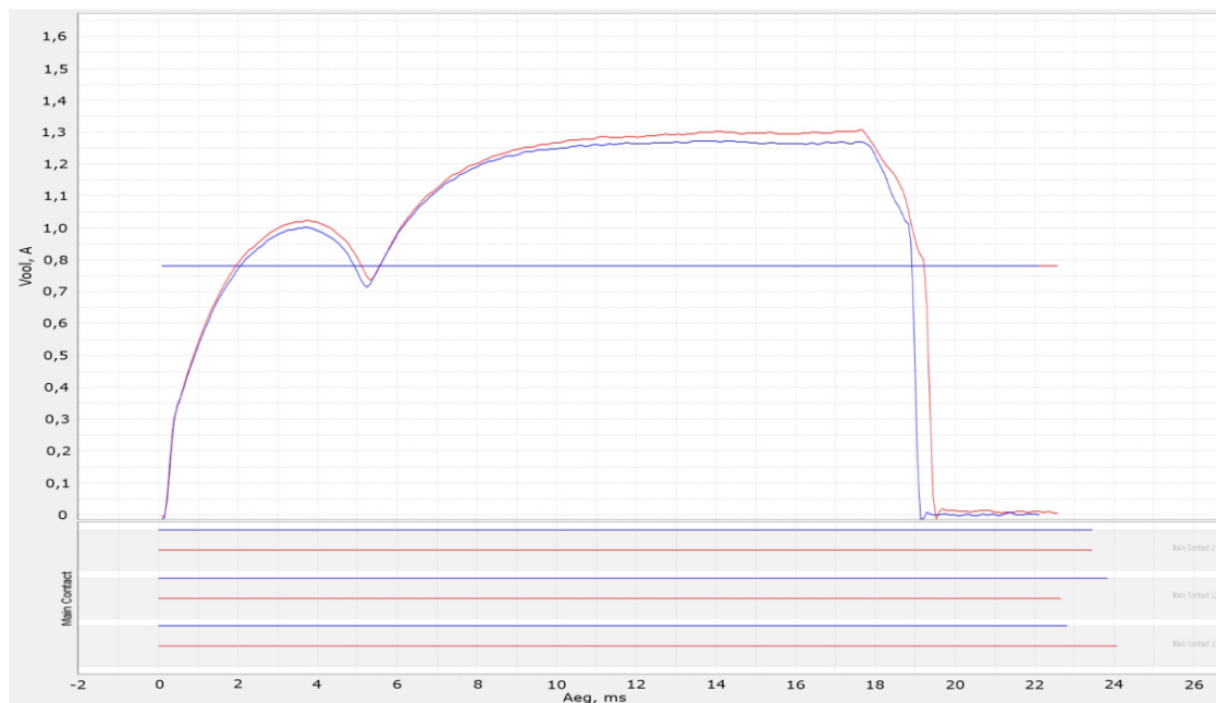
Joonis 1.15 Võimsuslüli väljalülitusel lülituspooli voolugraafik kasutades mõõteseadet Camlin Power Pro File P3 [27]
