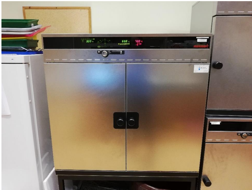
Joonis 3.7 Kuivatuskapp Memmert UFB-500 (erakogu)
