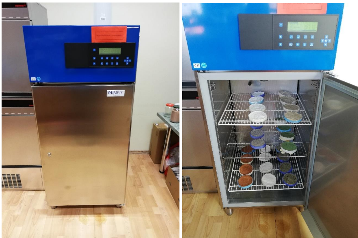
Joonis 3.8 Kliimakamber RUMED 4101 väljast ja seest (erakogu)
