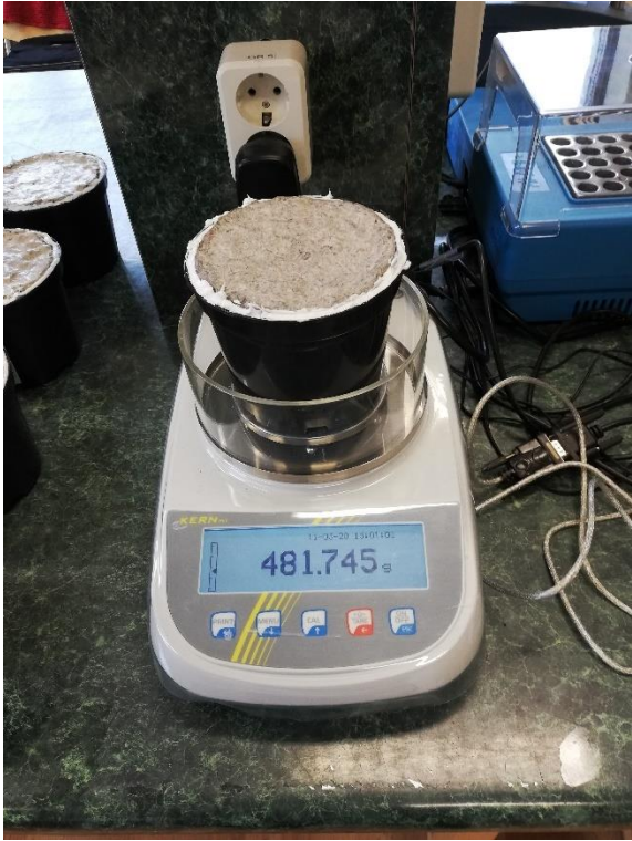
Joonis 3.9 Digitaalkaal Kern PLT 1200-3A (erakogu)
