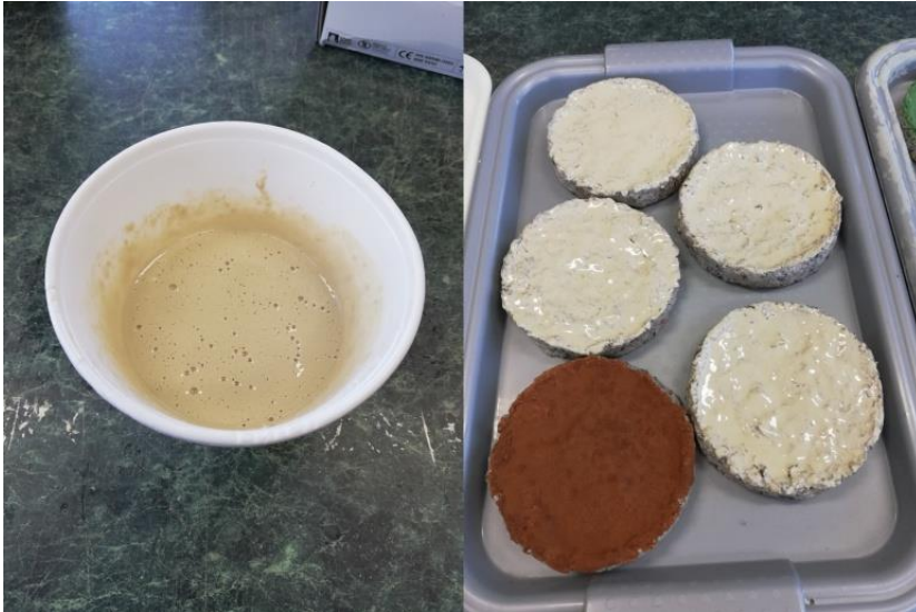
Joonis 3.3 Vasakul – valmistatud linaõlivärv. Paremal – 2x värvikihiga kaetud proovikehad (erakogu)
