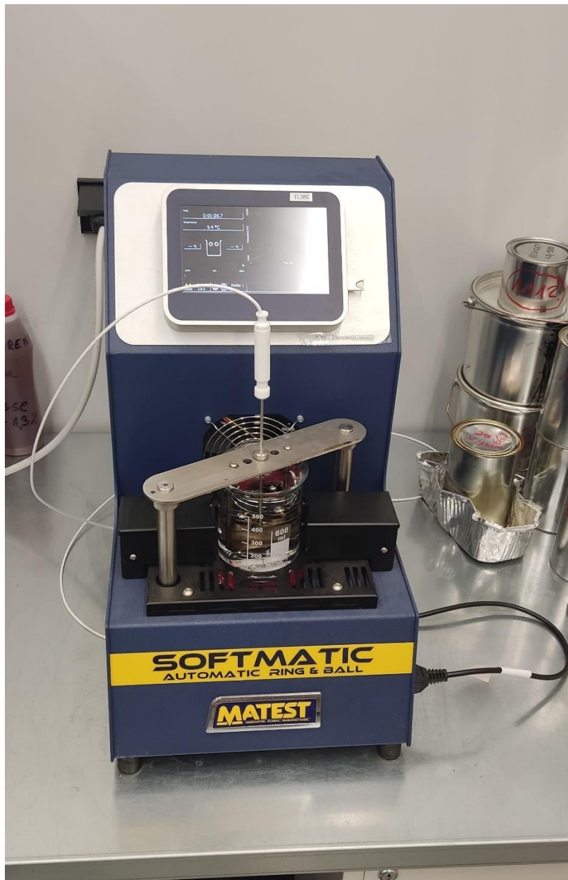
Joonis 5.2 Pehmenemistäpi määramine kuuli-rõnga meetodil
