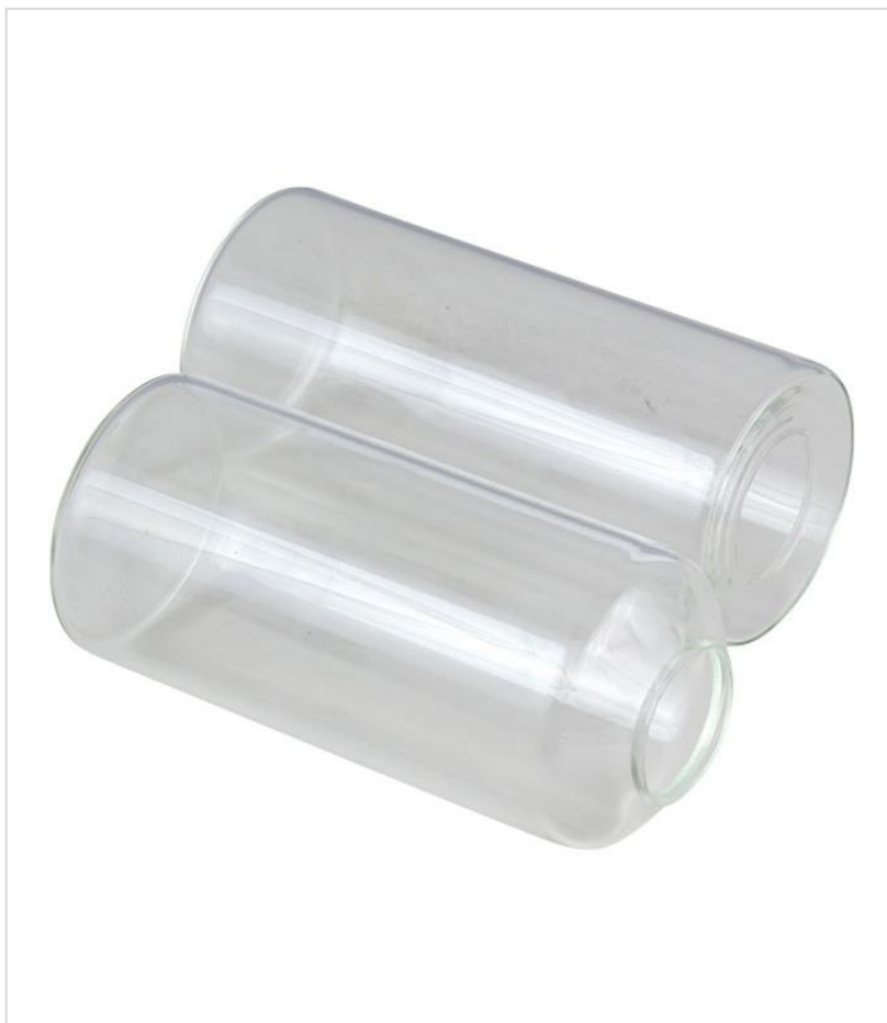
Joonis 6.7 Standardi EVS-EN 12607-1:2014 kohaselt lubatud kaks eri kujuga klaasanumat RTFOT katse läbiviimiseks [31]
