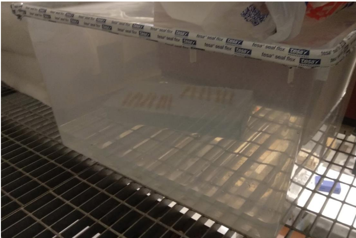
Joonis 2.4 90% niiskuskamber katsekehadele
