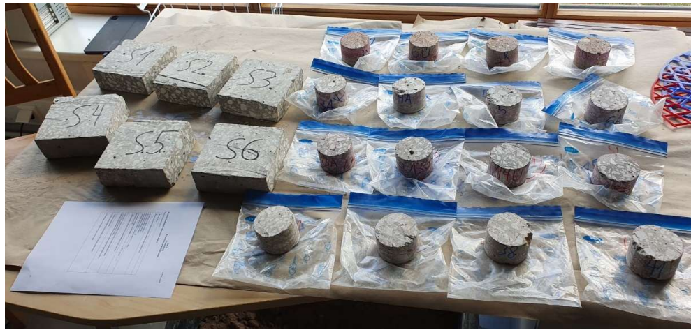
Joonis 3.17 Katsekehad enne külmumis-sulamis tsükleid
