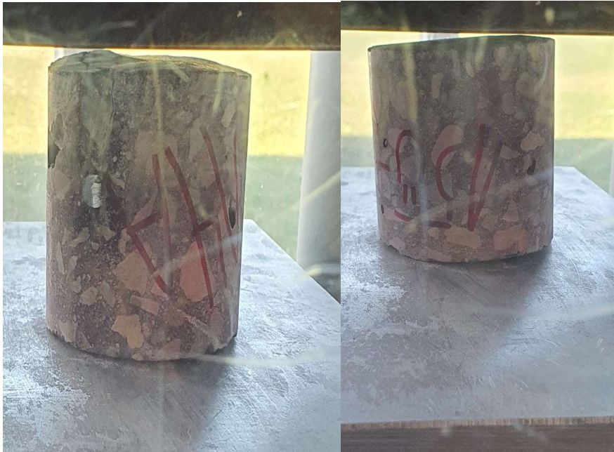
Joonis 3.14 Form-test pressi vahel olev katsekehad 14A ja 15Ü enne purustavat survekatset. Nende katsekehade tulemust arvutustes ei kasutatud.
