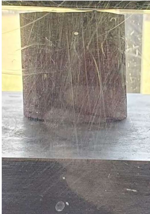
Joonis 3.11 Form-test pressi vahel olev katsekeha 1Ü enne purustavat survekatsset. Selle katsekeha tulemust edasistes arvutustes ei kasutatud
