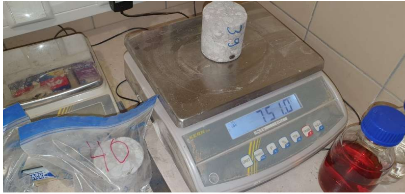
Joonis 2.13 Katsekeha kaalumine
