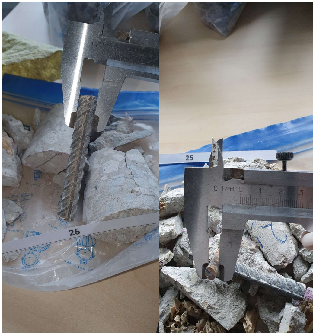
Joonis L6.1 Armatuurterase läbimõõdu mõõtmine nihikuga
