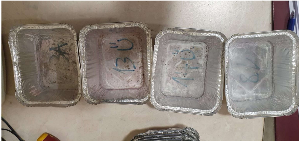
Joonis L5.3 Raudbetoontala katsekehade külmakindluse katse massikaod anumus peale 21. tsükli
