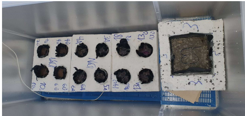
Joonis 2.17 Katsekehad vormides külmikus
