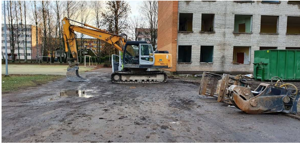
Joonis 2.3 Roomikekskavaator ning ehitusmasina lisaseadmed
