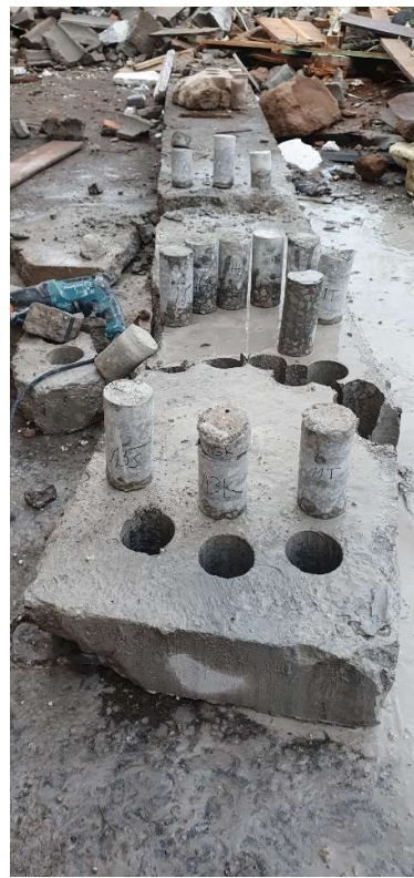
Joonis 2.6 Fotod uuritavast raudbetoontalast: a) ehitusobjektidel enne eemaldamist, b) raudbetoontala ehitusobjektidel peale maha tõstmist, c) kaasavõetud tala osa
