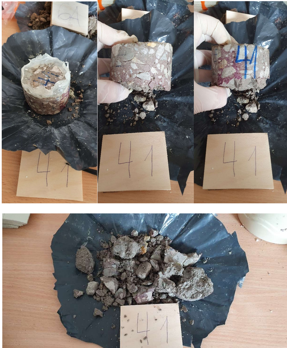
Joonis 3.21 Katsekeha 41 lahti monteerimine peale 28 külmumis-sulamis tsükli
