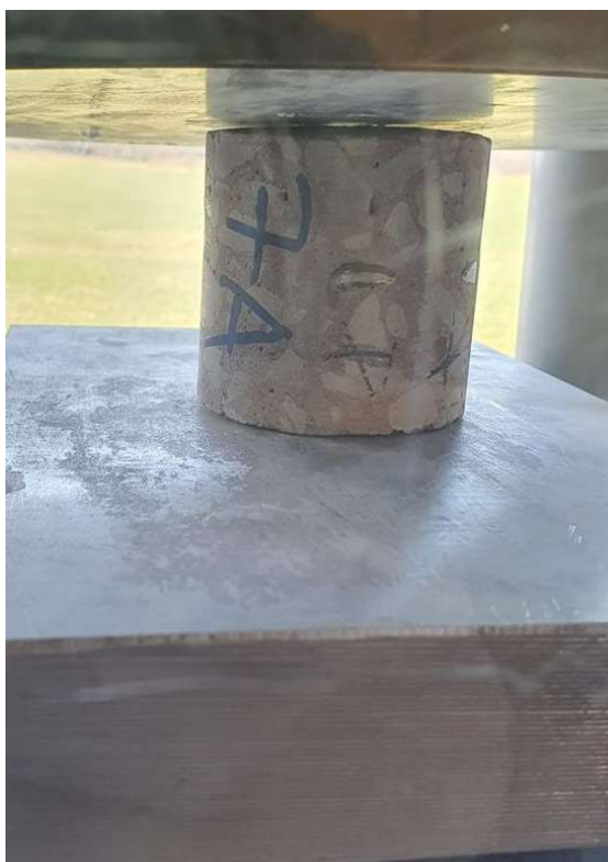
Joonis 3.12 Form-test pressi vahel olev katsekeha 7A enne purustavat survekatset. Selle katsekeha tulemust edasistes arvutustes ei kasutatud.
