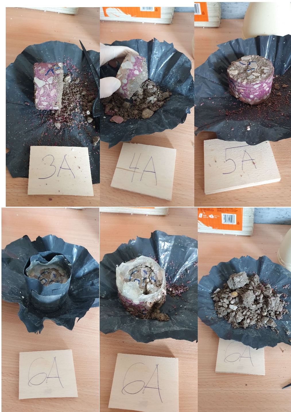
Joonis 3.19 Katsekehad 3A, 4A, 5A ja 6A pildid peale 28 külmumis-sulamis tsüklilt
