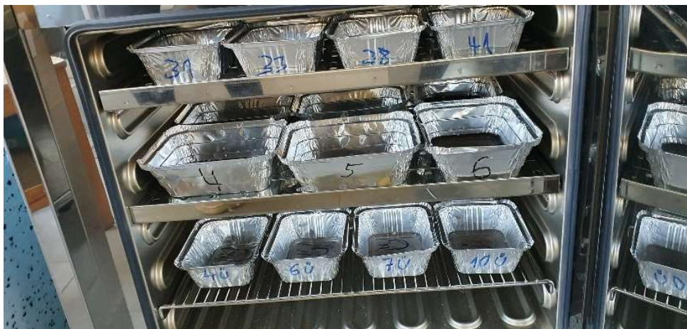
Joonis 2.20 Katsekehad alumiinium anumates ahjus
