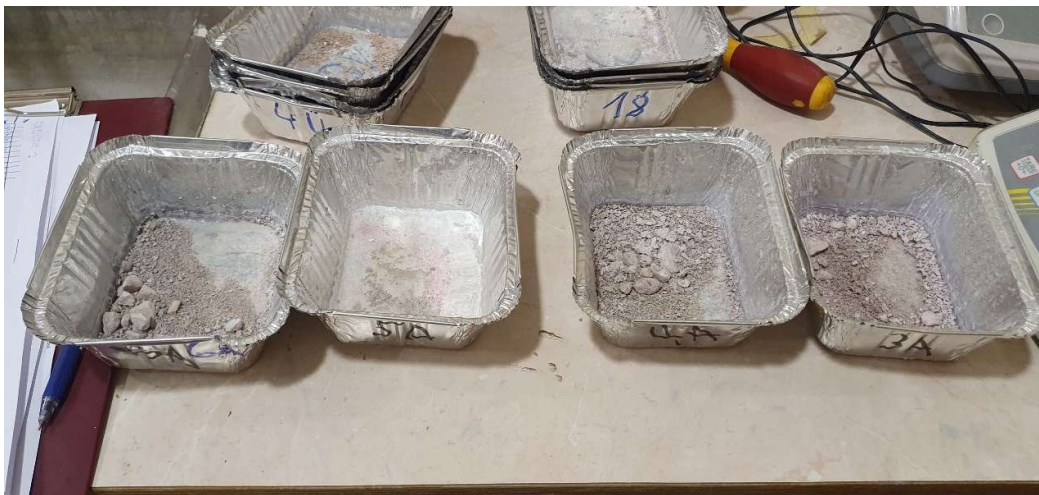
Joonis L5.1 Alumise mademe katsekehade külmakindluse katse massikaod anumad peale 21. tsükli
