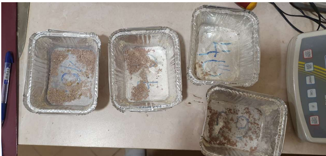
Joonis L5.2 Ülemise mademe katsekehade külmakindluse katse massikaod anumad peale 21. tsükli
