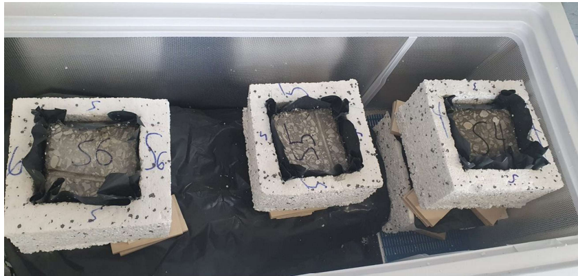
Joonis 2.18 Katsekehad vormides külmikus, osaliselt kaetuna
