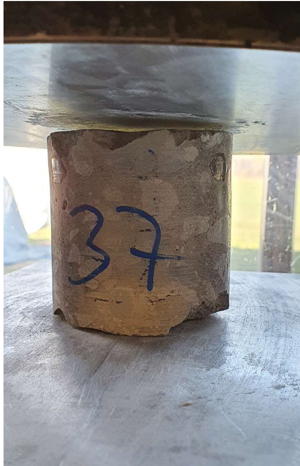
Joonis 3.13 Form-test pressi vahel olev katsekeha 37 enne purustavat survekatset. Selle katsekeha tulemust edasistes arvutustes ei kasutatud.
