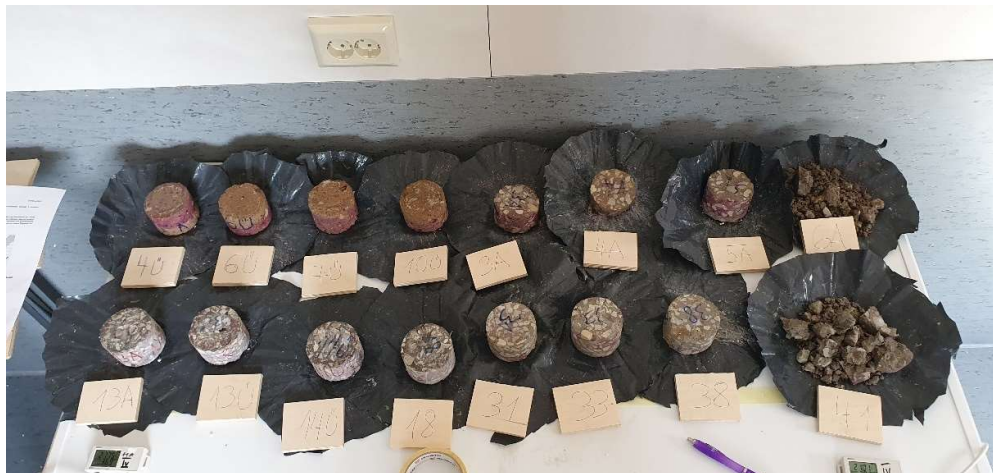
Joonis 3.18 Katsekehad pärast külmumis-sulamis tsükleid
