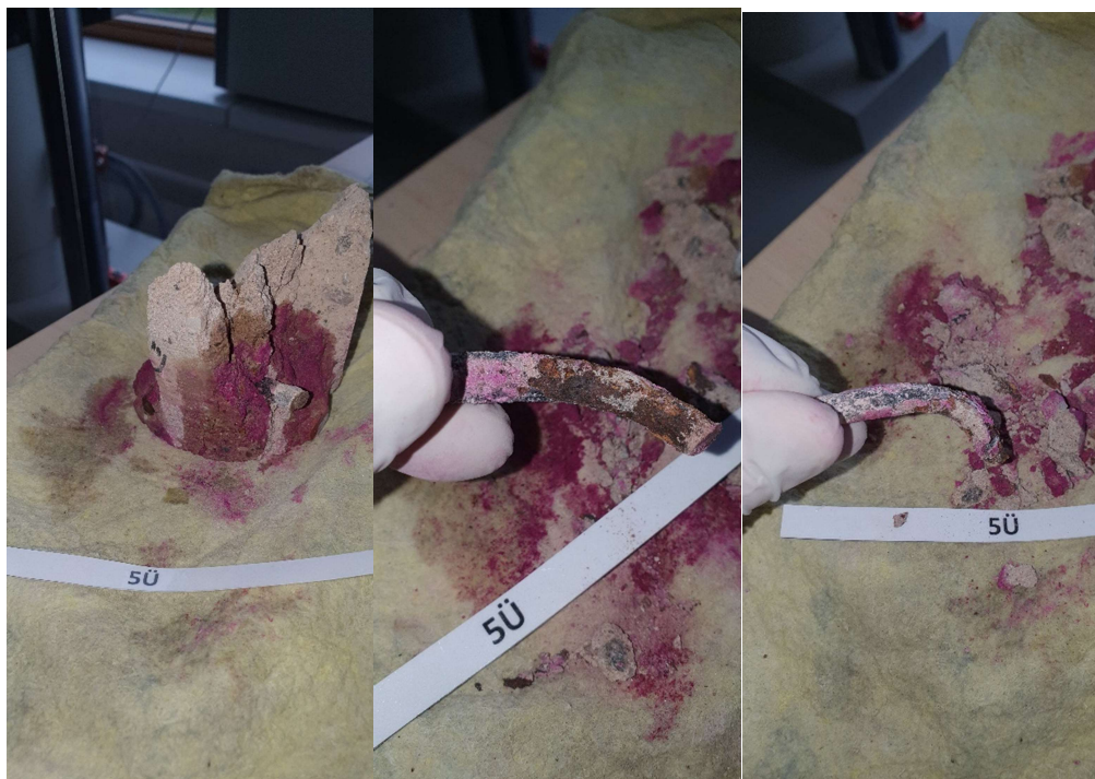
Joonis 3.6 Katsekeha 5Ü sisemine korrosiooniuring
