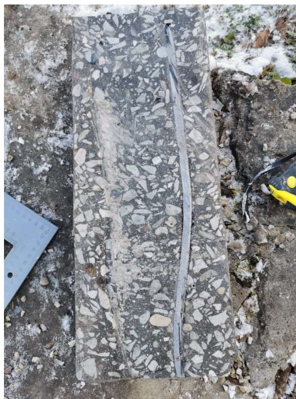
Joonis L4.2 Külmakindluse katsekehade lõikusel lõigati armatuuriga pikisuunas
