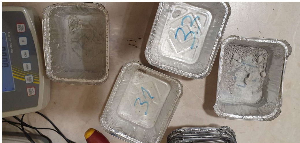
Joonis L5.4 Raudbetoonplaadi katsekehade külmakindluse katse massikaod anumus peale 21. tsükli
