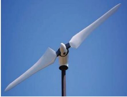
Joonis 2.4 Kahe labaga tuulegeneraator- [21]
