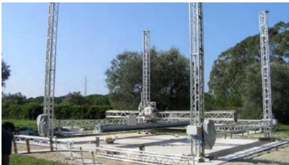
Joonis 1.4 D-Shape printimistehnoloogia [18]
