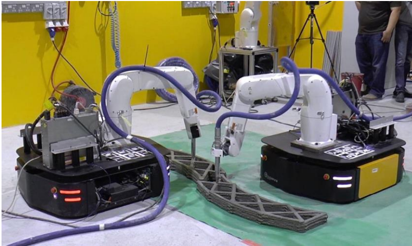
Joonis 1.9 Kaks robotit üheaegselt printimas swarm 3D meetodiga [21]
