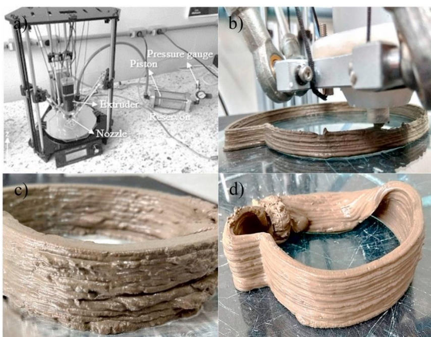
Joonis 1.11 Katsete [23] käigus tehtud fotod. a) katsetes kasutatud laboriprinter; b) filament, mis tekib materjalivoolu järsu seiskumise tõttu; c) ebaühtlane materjali pealevool; d) liiga madala voolavuspingega alumine kiht [23]
