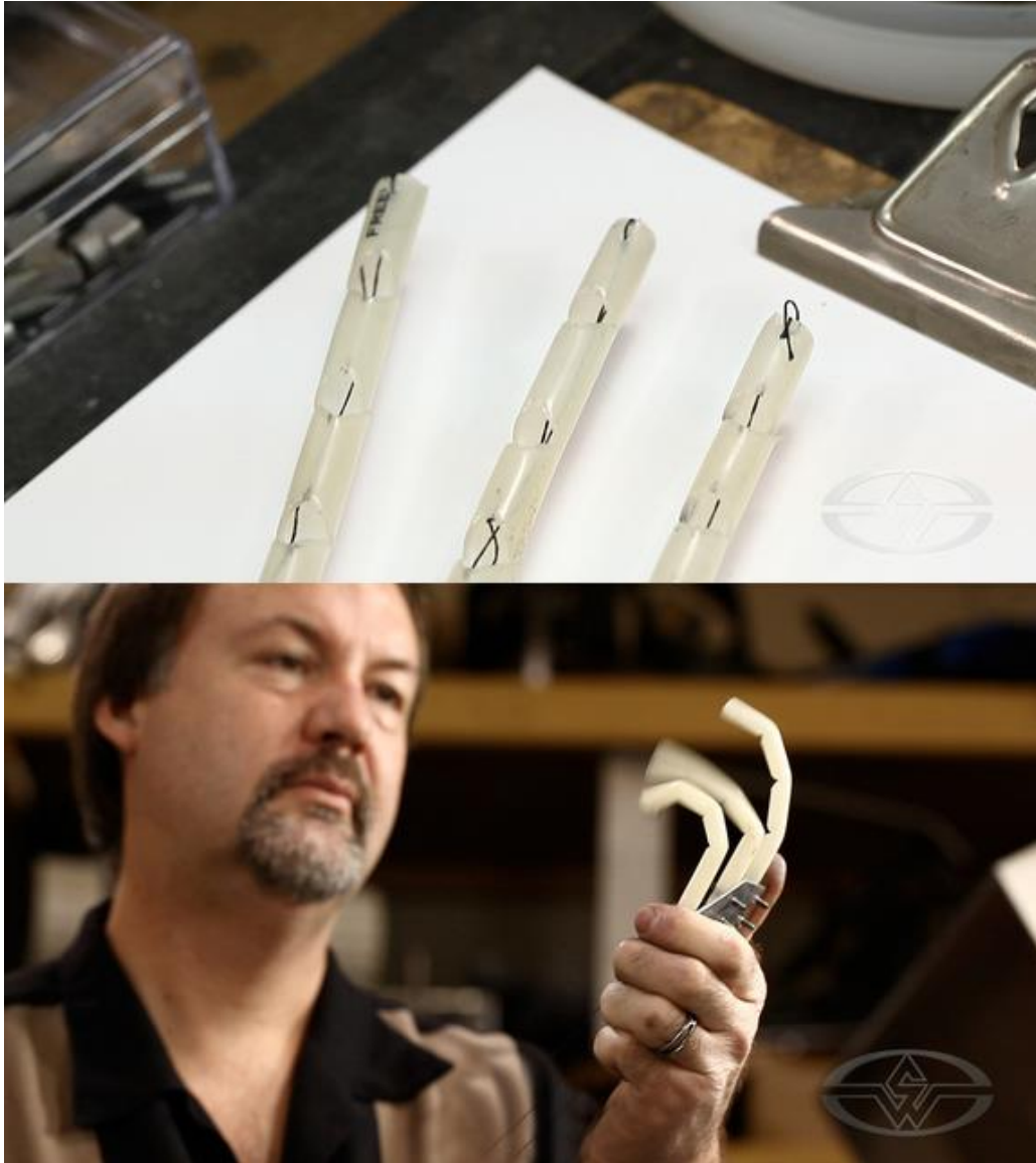
Joonis 4.18: Nailontoruga ühesuunalise mehhanismi näidis (Fotod: https://www.stanwinstonschool.com/blog/richard-landon-single-axis-hand-mechanism-mini )
