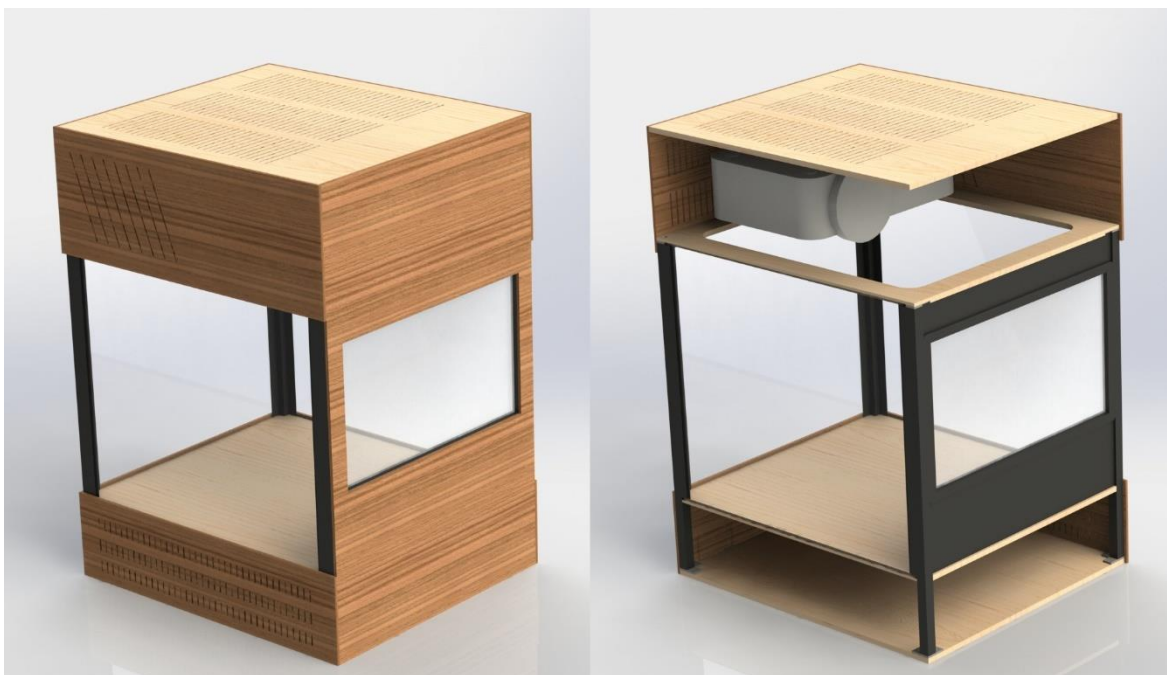
Joonis 3.2: Korpuse 3D mudel. Parempoolsel pildil on eemaldatud eesmine ja vasakpoolsed küljeplaadid.
