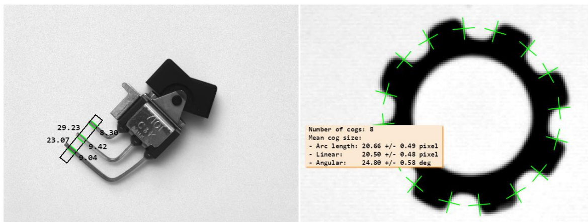
Рисунок 2. Измерение элементов деталей при помощи программы MVTech Halcon [3].
