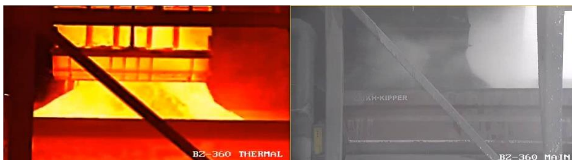
Рисунок 5. Сравнение тепловизионного потока видео с обычным.
