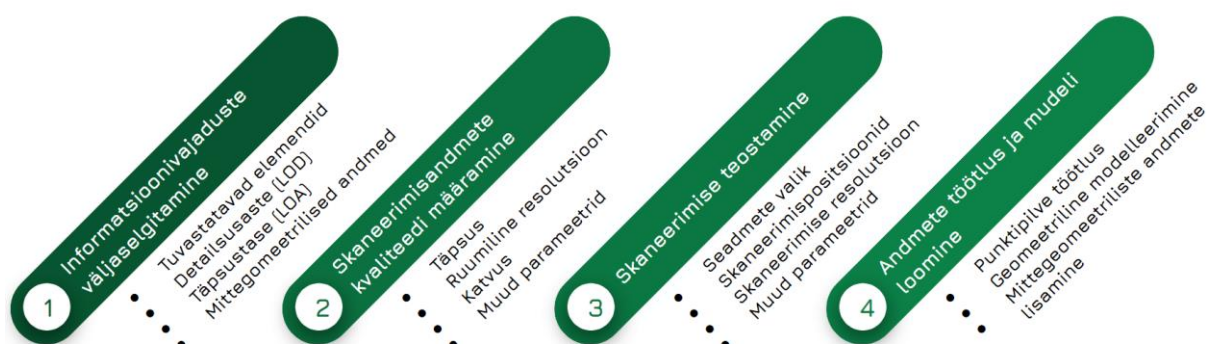
Joonis 1.1 Scan to BIM töövoog (Wang, Guo, Kim. 2019)
