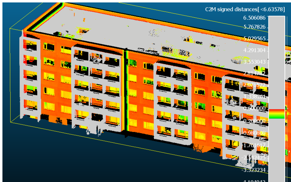
Joonis 3.3 Punkt pilve võrdlus mudeliga Akadeemia tee 5a näitel CloudCompare programmis
