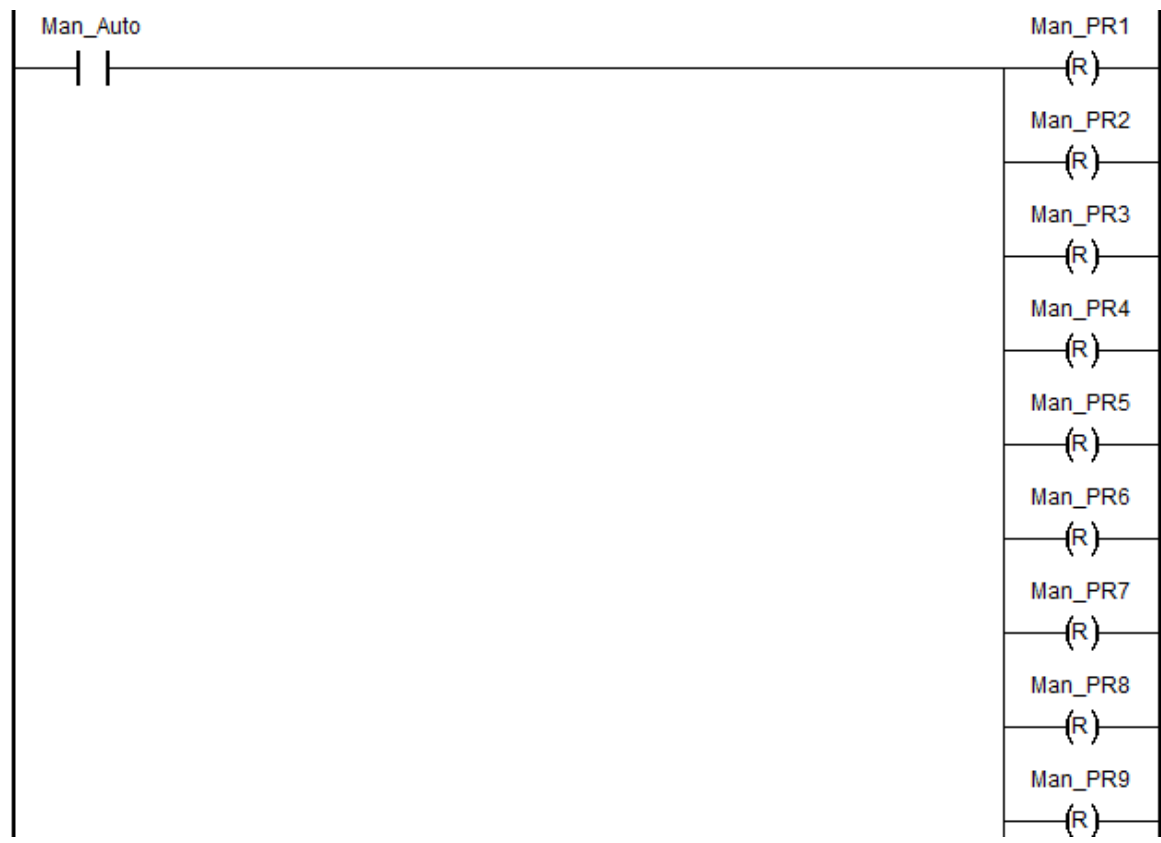
Рисунок 18. Пример сброса значения тегов ручного управления при включении в автоматический режим.
