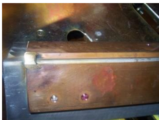
Joon.5.17 Jahutusplaadid (copper chill, Euroopas heat sink)
