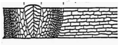
Joon. 5.33 Deformeeritavast sulamist keevisliite struktuur
