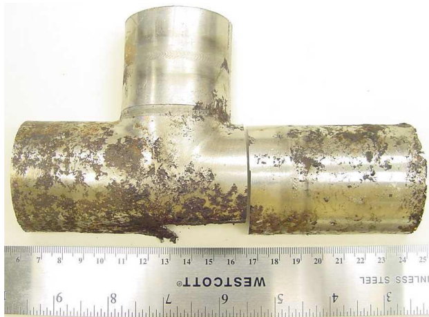
Joon. 5.15 Töö 7 aastat korrodeeruvus keskkonnas 90°C kraadi ja rõhul. Seespool väikesed praod.
