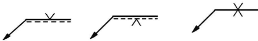
Joon. 3.23 V-õmbluse tähistus: a-noole pool; b)-teisel pool; c) X-õmblus, sümmeetriline kahepoolne V-õmblus, puudub katkend-viitejoon
