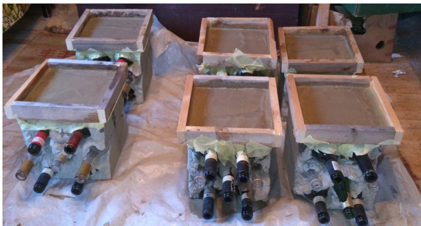
Joonis 2.4 Klaaspudelplokkide tasandamine tasandussegu (Foto: Triin Tõnisson)
