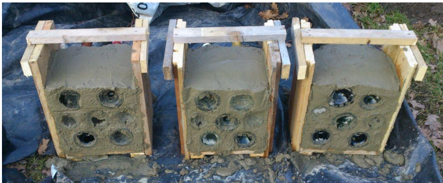
Joonis 2.3 Klaaspudelplokkide valmistamine (Foto: Triin Tõnisson)
