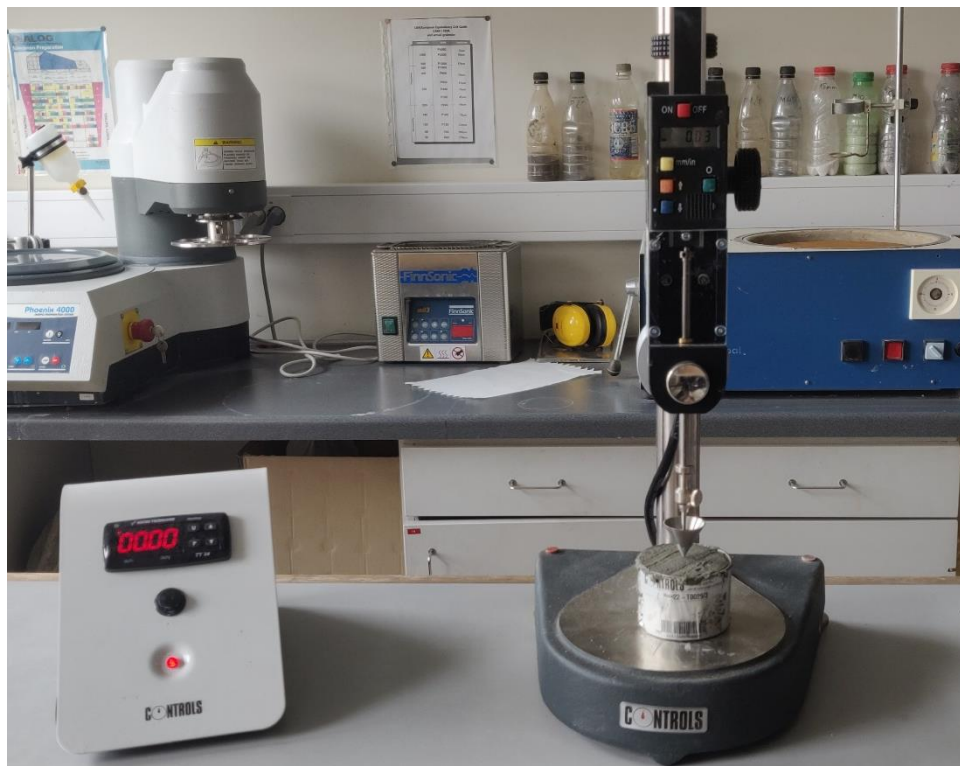
Joonis 15. Voolavuspiiri leidmiseks kasutatud penetromeeter Controls model 22-T0029/E.
