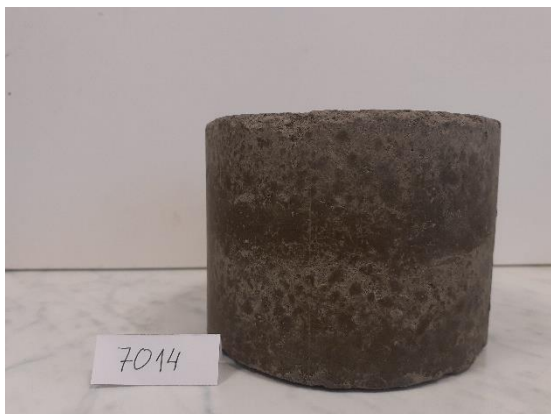
Joonis 21. Standard Proctorteimiga tihendatud proov, enne survetugevusteimi.
