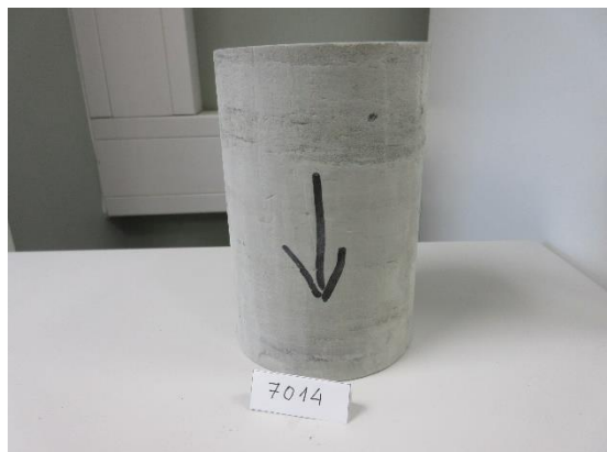
Joonis 18. Varangu kihistu savi kuivanud katsekeha (OV005-2021) enne survetugevusteimi.
