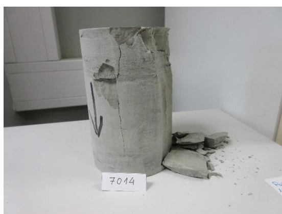
Joonis 19. Varangu kihistu savi kuivanud katsekeha (OV005-2021) peale survetugevusteimi.
