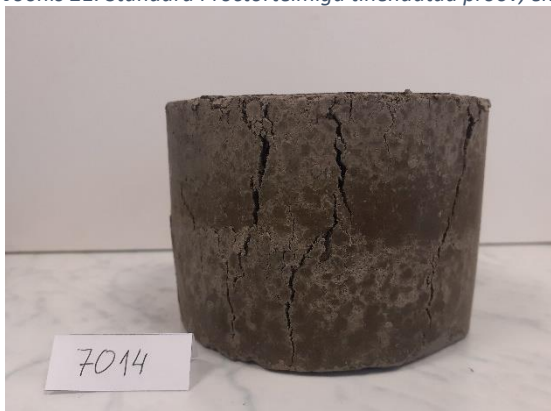
Joonis 22. Standard Proctorteimiga tihendatud proov, peale survetugevusteimi.
