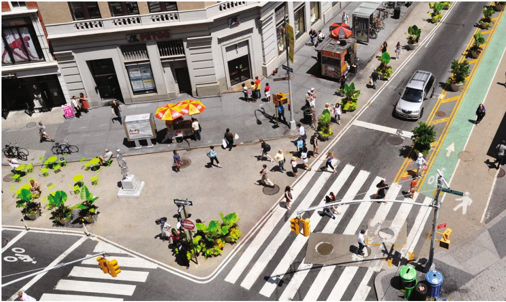
Joonis 2.17 Ristmikul ülemineku lahendusena jalgteede laiendamine [13]
