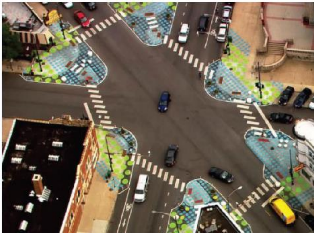
Joonis 2.11 Ülemineku lahendus ristmiku pöörderaadiuste vähendamiseks [9]
