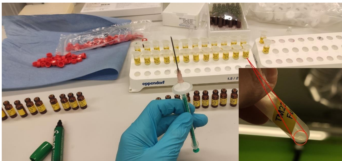
Joonis 6.1 1 mL süstal koos süstlafilttri- ja nõelaga, mille tagataustal on näha etiketeeritud mikroviaale (2 mL, Eppendorf ) ja GC viaale (0,2 mL) (autori foto)
