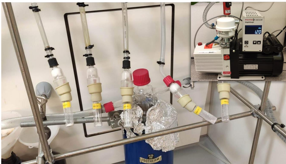
Joonis 5.18 Vaakumkollektoriga ühendatud MOF-e sisaldavad viaalid; üleval vasakul on foto õli vaakumpumbast koos digitaalse rõhumõõdikuga (autori foto)
