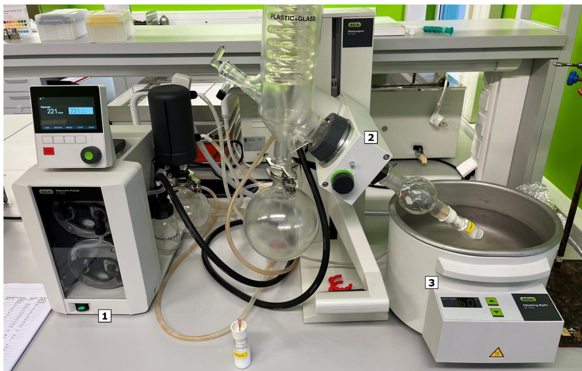
Joonis 5.17 Büchi rotaatoraurusti; all vasakul on näide MOF-iga viaalist, kust aurutatakse välja AcN-i; 1 – Büchi vaakumpump; 2 – Büchi pöörlev vaakumipea koos jahuti ja kogumisnõuga; 3 – Büchi termostaatiline veevann (autori foto)
