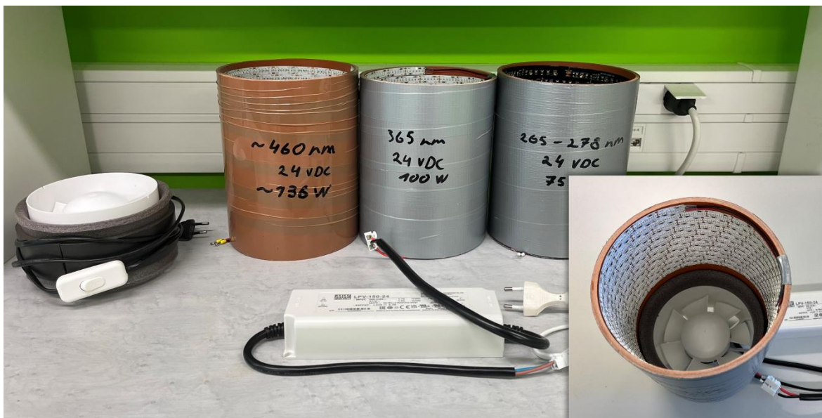
Joonis 5.11 Autori poolt valmistatud UV-valgustatavad silindertorud
