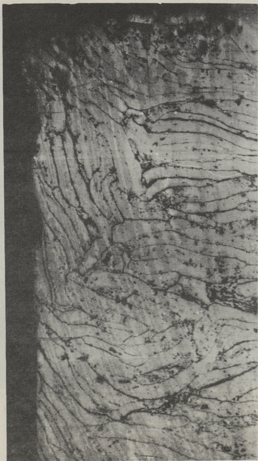
Фиг. 3. Микроструктура кромки магнитопровода вблизи стенки матрицы. Верхний край образца. Давление прессования 1400 \text{ MN/m}^2 . Увеличение 60\times .
