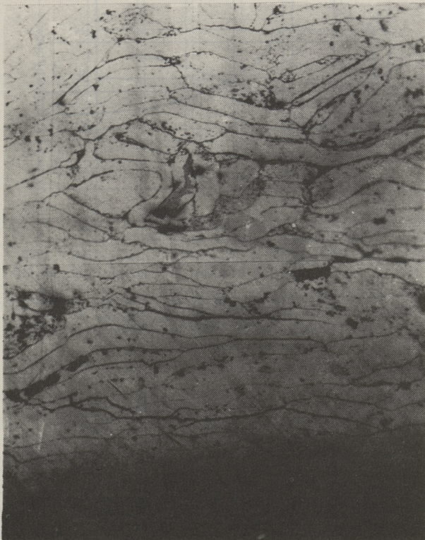
Фиг. 5. Микроструктура магнитопровода с искажением ориентации чешуек железа при их засыпке. Давление прессования 1400 \text{ МН/м}^2 . Увеличение 60\times .
