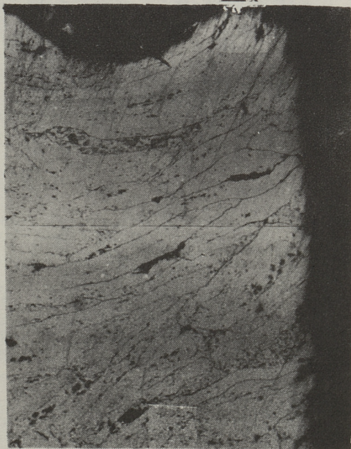
Фиг. 1. Микроструктура кромки магнитопровода вблизи стенки матрицы. Верхний край образца. Давление прессования 500 МН/м. Увеличение 60х.
