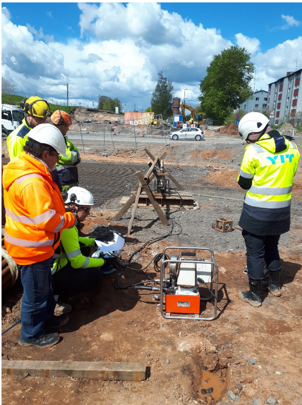
Foto 14: Vaiade katsetamine tõmbele (Foto autor: Ildar Sagetdinov)
