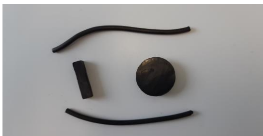
Joonis 15 Ekstrudeeritud ribad koos katsekehadega
