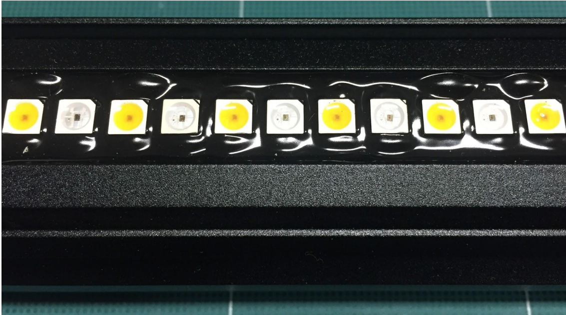
Joonis 5. Valumassi pinna alla jäänud õhumullid
