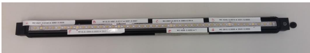
Joonis 16. Testobjekt, millel on juhusliku valimi alusel mõned LED'id katvast valumassist puhastatud ja võrreldud lähedal paiknevate puhastamata LED'idega
