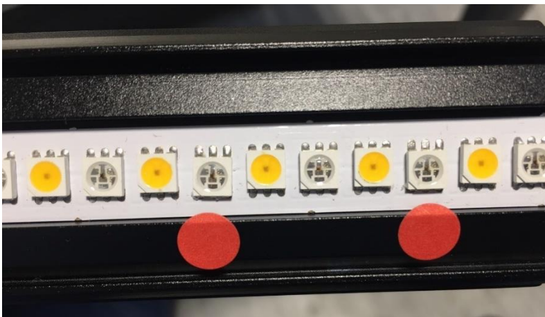
Joonis 27. Ekstreemse kõrvalekaldega LED'id (tootmiseks sobimatu)
