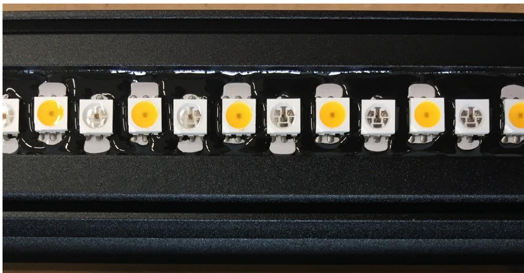
Joonis 37. Korrektnen siksak, valumass on nähtavalt ka LED'ide alla voolanud
