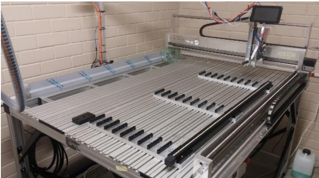
Joonis 28. CNC pingi modifitseeritud tööpind, hoidikud 10'ne Voyager'i jaoks
