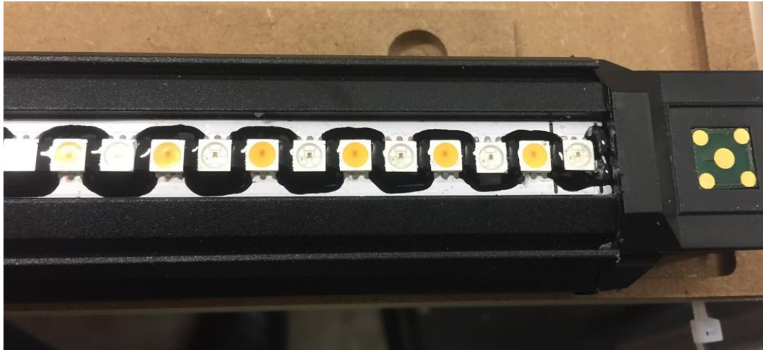
Joonis 36. LED'ide vaheline alatäituvus
