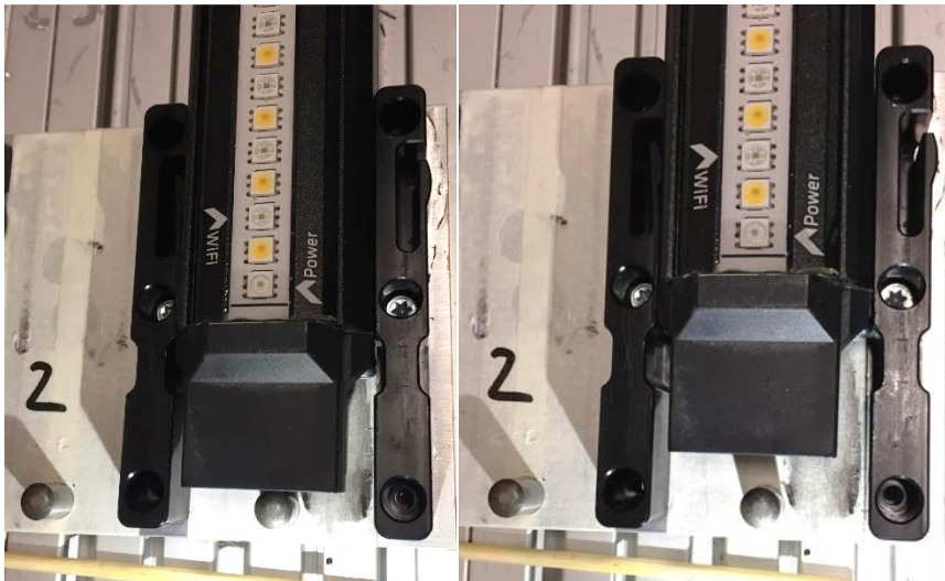
Joonis 29. Ühe VG'i hoidiku pealtvaade, otsas 0-positsiooni stopper
