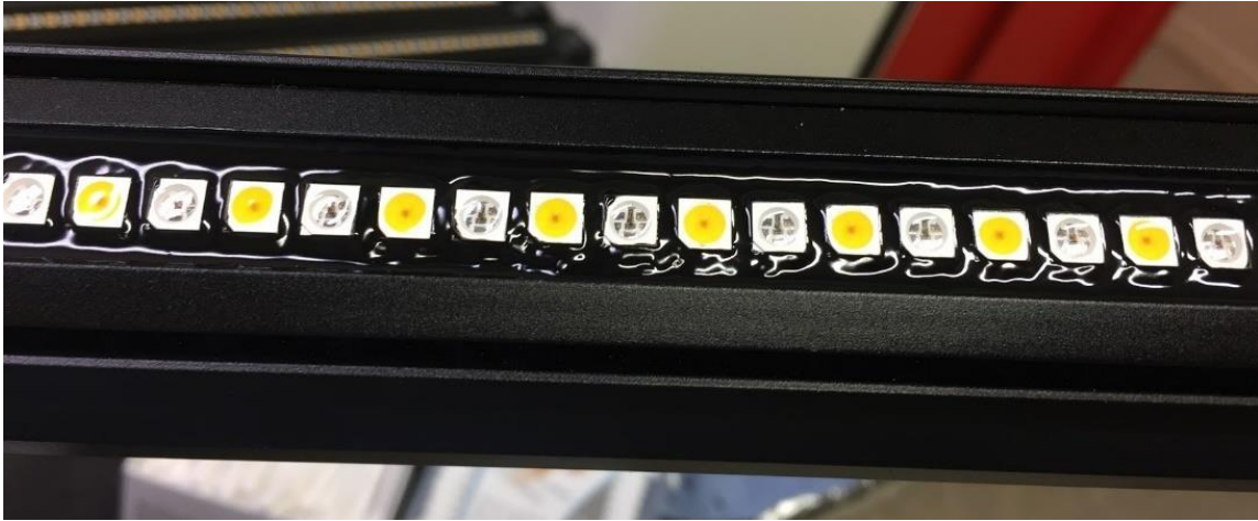
Joonis 26. LED'ide peale sattunud valumass
