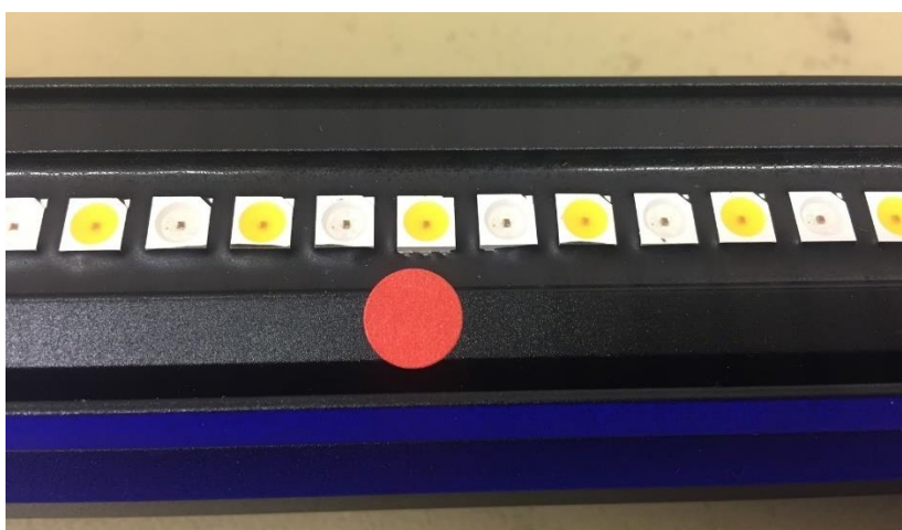
Joonis 38. Märkamata jäänud külgedel paiknevad LED'i jootekohad
