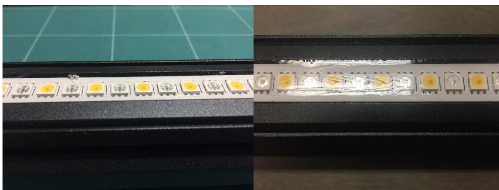
Joonis 15. Mullid valumassis ja eemaldamisest põhjustatud pinnalainetus
