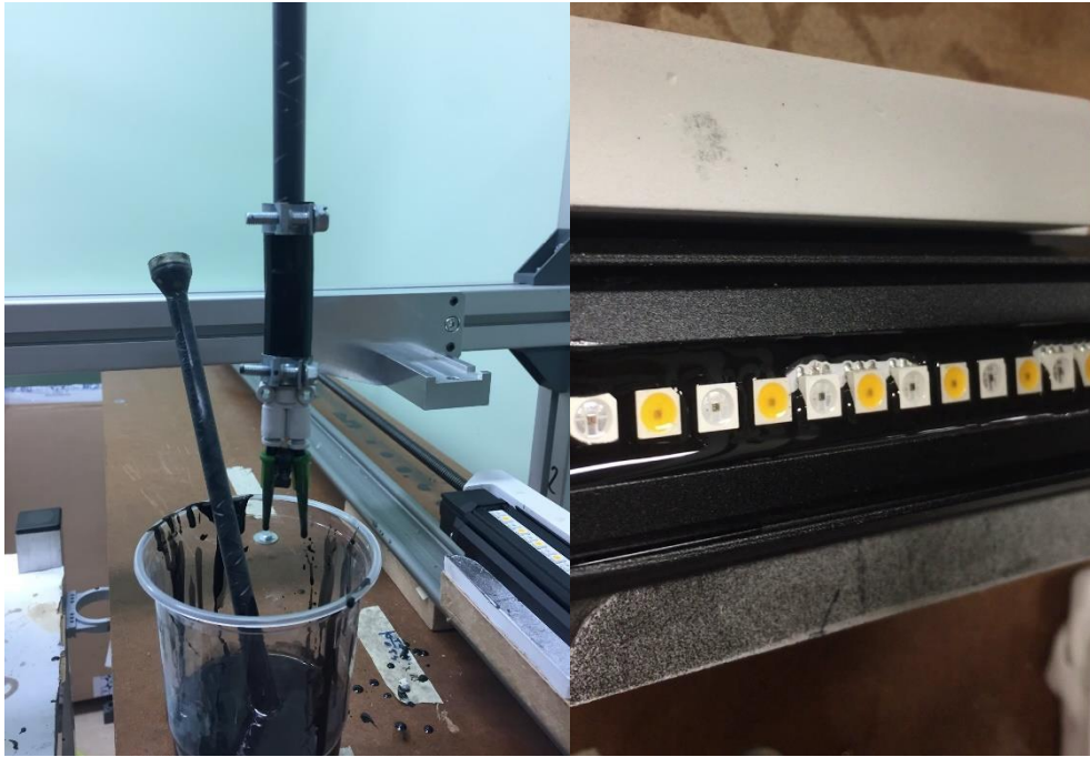
Joonis 19. Kaheharuline otsak ja ebahütlane valumass mikseri manuaalse hoidmise tõttu
