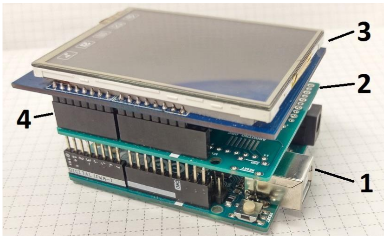
Sele 6.2.1 Arduino ühendus: 1 – Arduino UNO, 2 – Arduino Proto, 3 – ekraan, 4 – piigiribad.
