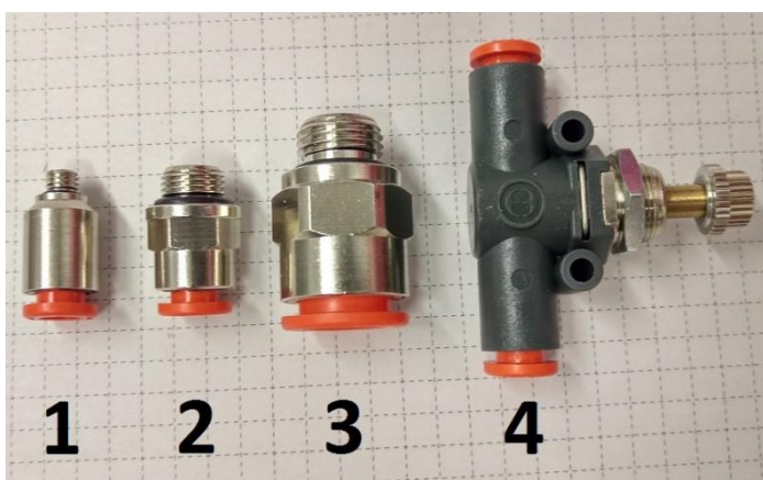
Sele 5.7.1 Vesijahutusploki liitmikud: 1 – veebloki sirge liitmik, 2 – plaatliitmiku väljalaske liitmik, 3 – plaatliitmiku sisselaske liitmik, 4 – drossel (vooluregulaator).
