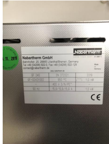
Joonis 2.3 Sulatusahi Nabertherm SF240 HYTI Design klaasistuudios (Autori foto)
