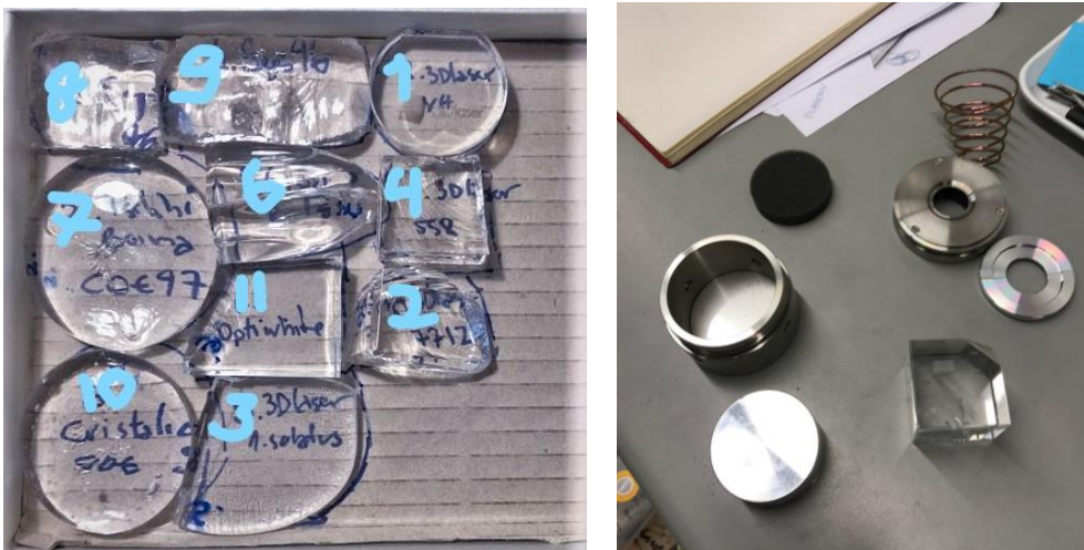
Joonis 2.2 Klaasiproovid ja röntgenfluoresents-spektromeetria masina proovinõu (Autori fotod)
