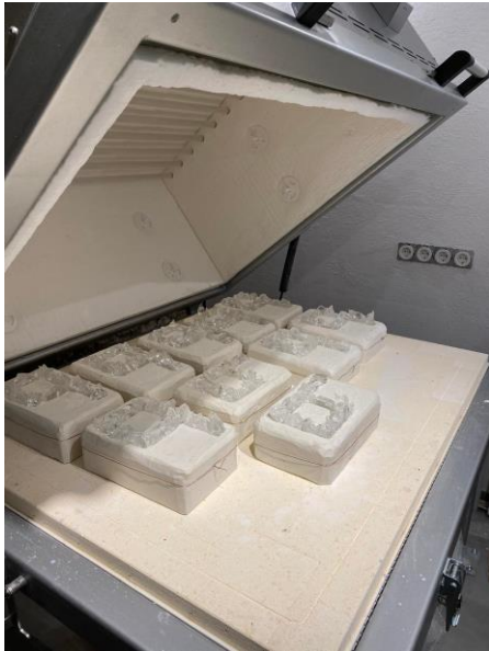
Joonis 2.3 Sulatusahi Nabertherm SF240 HYTI Design klaasistuudios (Autori foto)
