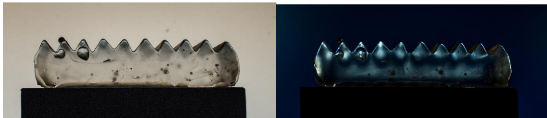
Joonis 3.10 Katsekeha 2 tavalises ja ristpolariseeritud valguses. Pealt ja kõrvalt vaates (Autori pildid)
