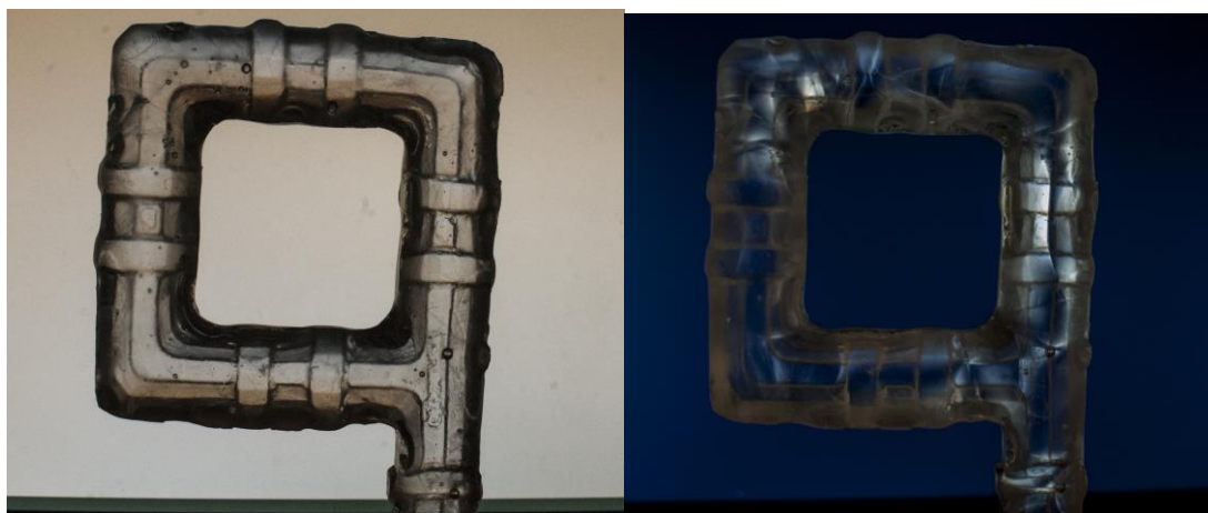
Joonis 3.12 Katsekeha 4. Tavalises ja ristpolariseeritud valguses ( Autori fotod)
