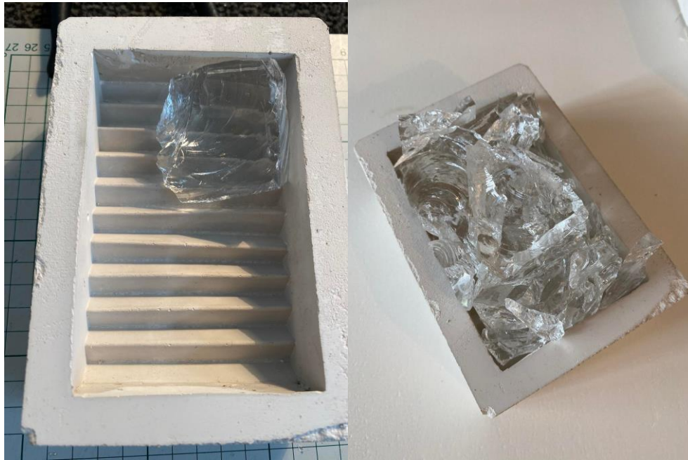
Joonis 2.6. Katseobjekt 2 vorm ja vorm klaasiga enne sulatust (A-L.Leht foto).
